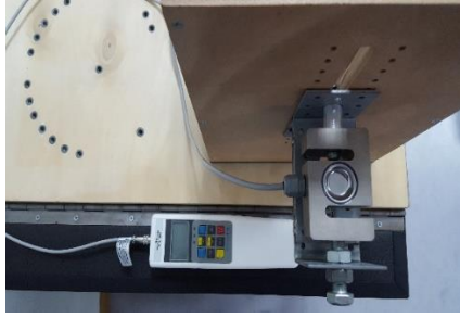
Εικόνα 3.8. Συσκευή ψηφιακής απεικόνισης και δυναμοκυψέλη σταθεροποιημένη στην ειδικά διαμορφωμένη ξύλινη κατασκευή
