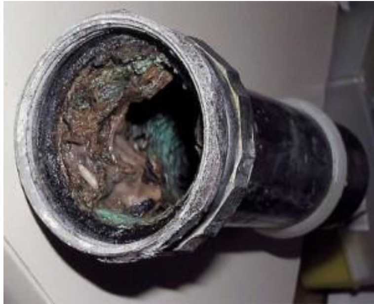
Εικόνα 17 : Βιοφίλμ σε σωλήνωση
