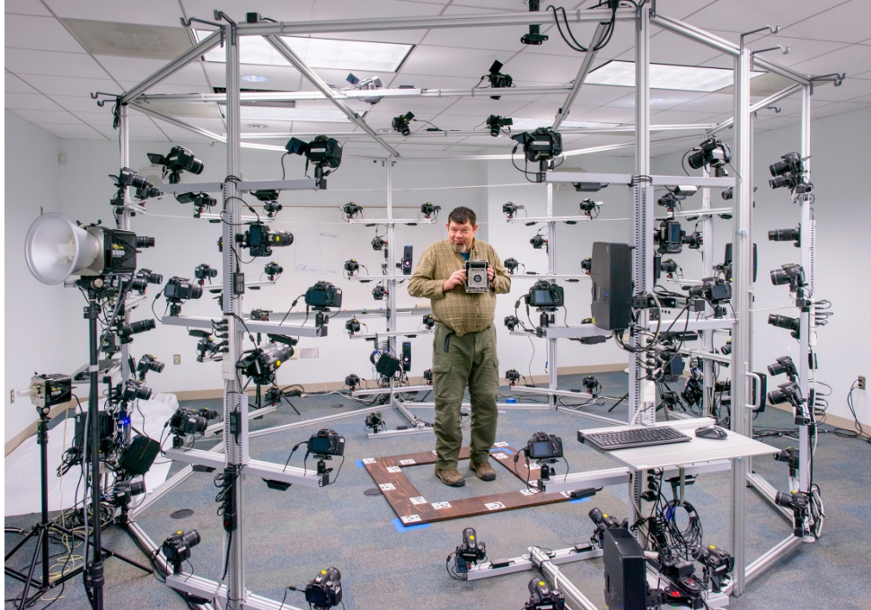
Εικόνα 6: Σύστημα φωτογραμμετρίας με 90 DSLR κάμερες, που δημιουργήθηκε το 2015 από την UMBC, για δημιουργία ψηφιακών ανθρώπινων μοντέλων και για τη μελέτη διαφόρων ειδών κίνησης.
