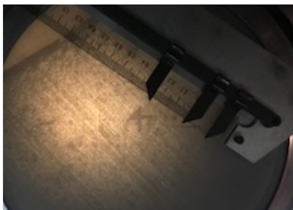
Εικόνα 10 :εντύπωμα κατά τη σκληρομέτρηση
