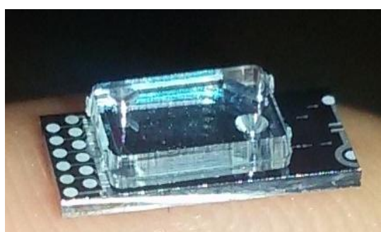
Εικόνα 4.5: Ψηφίδα πυριτίου στην επιφάνεια της οποίας έχει τοποθετηθεί μικρορευστομηχανική κυψελίδα από πολυ(μεθακρυλικό μεθυλεστέρα) (PMMA) πάχους 800 \mu\text{m} η οποία φέρει οπές για την είσοδο/έξοδο των διαλυμάτων
