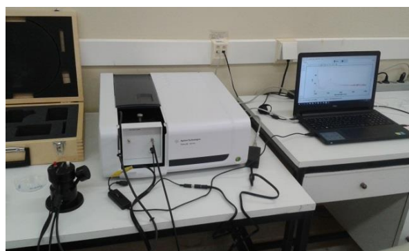
Σχήμα 2.4: Φασματοφωτόμετρο Agilent Cary 60 (αριστερά) και η σύνδεση του με τη διάταξη διάχυτης ανακλαστικότητας μέσω οπτικής ίνας (δεξιά).
