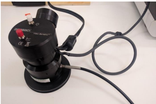
Σχήμα 2.7: Συσκευή (αριστερά) και οπτικό σύστημα (δεξιά) διάχυτης ανακλαστικότητας.
