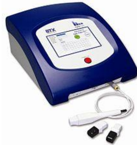
Εικόνα 1.6: Σύστημα ηλεκτροδιάρτησης για πειραματική χορήγηση εμβολίου DNA
