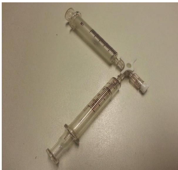
Εικόνα 4. Διάταξη ομογενοποίησης διαλύματος μυοσίνης.
