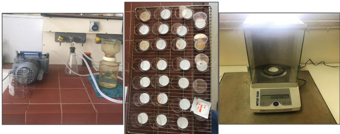
Σχήμα 4.5 Διαδικασία εργαστηριακών διηθήσεων α. όργανο διήθησης, β. ηθμοί και γ. ζυγός ζύγισης ηθμών πριν και μετά τη διήθηση.
