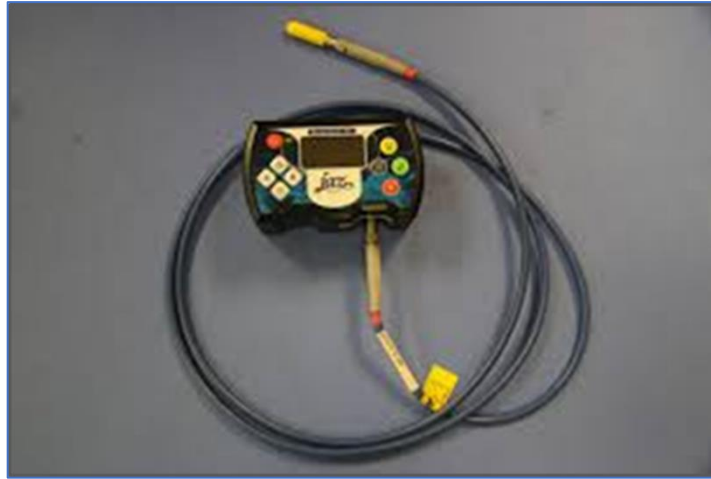
Σχήμα 4.7 Φασματοφωτόμετρο χειρός JAZ της Ocean Optics, με το οποίο συλλέχθηκαν μετρήσεις υπερφασματικής ανακλαστικότητας.
