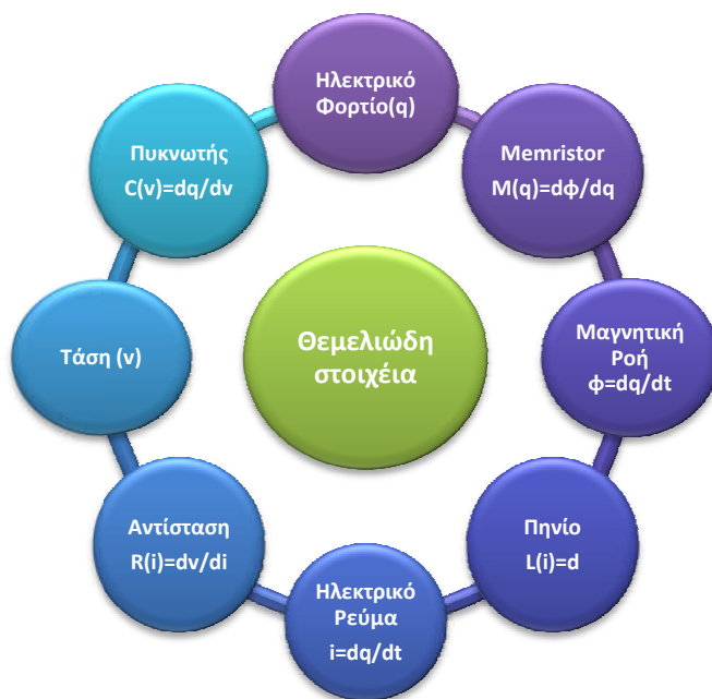
Εικόνα 1.1 Τα θεμελιώδη ηλεκτρικά στοιχεία (πηνίο, πυκνωτής, αντίσταση και memristor) και η συσχέτιση με τα τέσσερις θεμελιώδεις ηλεκτρικές μεταβλητές ( τάση, ηλεκτρικό φορτίο, μαγνητική ροή και ηλεκτρικό ρεύμα).
