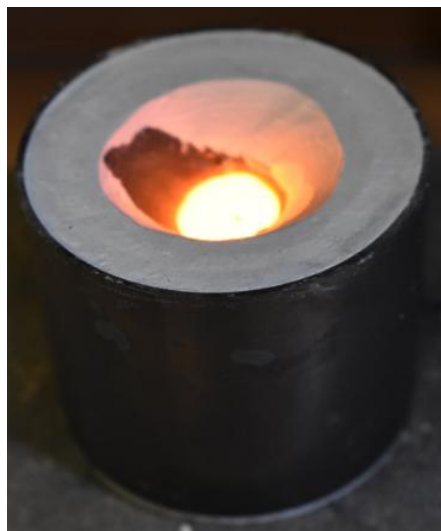
Εικόνα 34: Ο δακτύλιος χύτευσης μετά την πλήρωσή του με λειωμένο κράμα Co-Cr και την αφαίρεσή του από την συσκευή χύτευσης.
