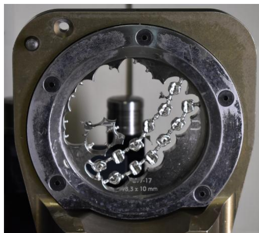
Εικόνα 40: Το μπλοκ κράματος Co-Cr σκληρής κοπής στο μηχάνημα CAM μετά το τέλος της διαδικασίας παραγωγής των σκελετών Co-Cr.
