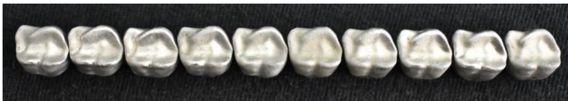
Εικόνα 38: Οι σκελετοί Co-Cr επιεμφυτευματικών συγκολλούμενων μεταλλοκεραμικών στεφανών πρώτου γομφίου της θέσης 26 των οδοντικών τόξων της μεθόδου μαλακής κοπής.
