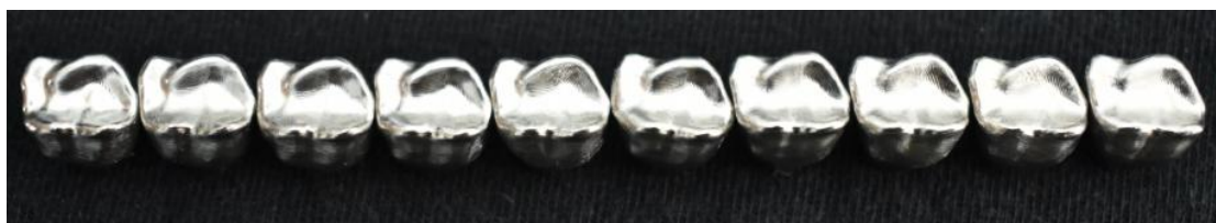
Εικόνα 41: Οι σκελετοί Co-Cr επιεμφυτευματικών συγκολλούμενων μεταλλοκεραμικών στεφανών πρώτου γομφίου της θέσης 26 των οδοντικών τόξων της μεθόδου σκληρής κοπής.
