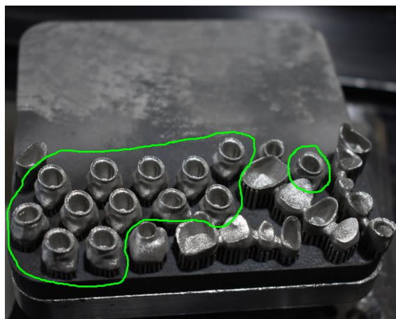
Εικόνα 43: Οι 13 σκελετοί Co-Cr επιεμφυτευματικών συγκολλούμενων μεταλλοκεραμικών στεφανών πρώτου γομφίου της θέσης 26 των οδοντικών τόξων (μέσα στους ζωγραφισμένους επί της εικόνας πράσινους κύκλους) στην πλατφόρμα κατασκευής, μετά την κατασκευή τους με την μέθοδο της επιλεκτικής τήξης με laser.
