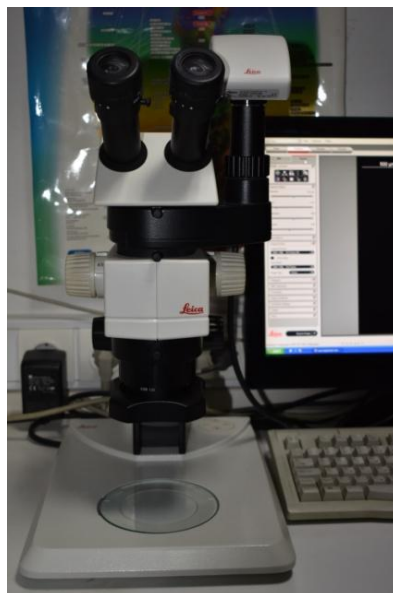
Εικόνα 45: Το στερεομικροσκόπιο M80 με την φωτογραφική κάμερα στερεομικροσκοπίου DFC295.
