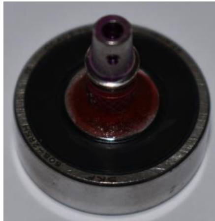
Εικόνα 48: Το ρουλεμάν με το ενσωματωμένο επιεμφυτευματικό στήριγμα.
