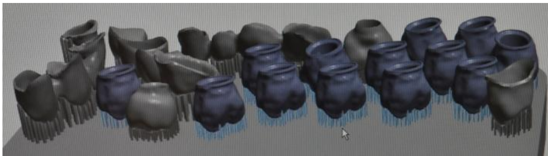
Εικόνα 42: Οι 13 εικονικοί σκελετοί επιεμφυτευματικών συγκολλούμενων μεταλλοκεραμικών στεφανών πρώτου γομφίου της θέσης 26 των οδοντικών τόξων (μπλε χρώμα) με τις συγκρατητικές τους δομές επί της εικονικής πλατφόρμας κατασκευής.
