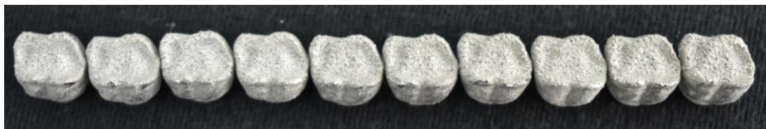
Εικόνα 44: Οι σκελετοί Co-Cr επιεμφυτευματικών συγκολλούμενων μεταλλοκεραμικών στεφανών πρώτου γομφίου της θέσης 26 των οδοντικών τόξων της μεθόδου επιλεκτικής τήξης με laser.
