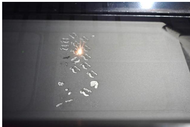
Εικόνα 5: Η διαδικασία κατασκευής σκελετών Co-Cr ακίνητων προσθετικών αποκαταστάσεων με την μέθοδο της επιλεκτικής τήξης με laser σκόνης κράματος Co-Cr. 37
