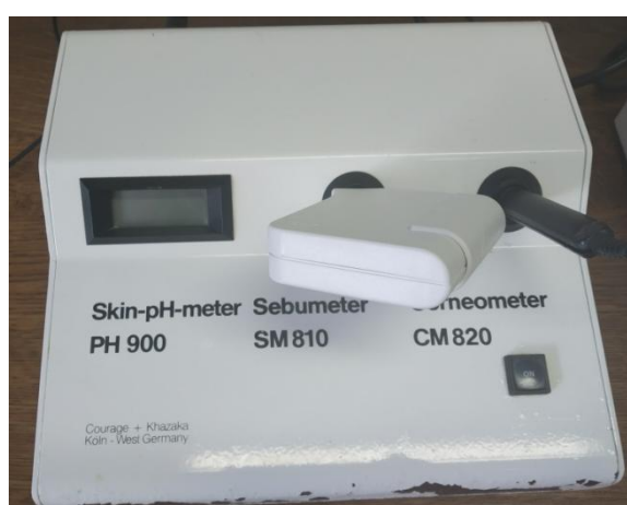
Εικόνα 15 Όργανο μέτρησης ενυδάτωσης και σμήγματος (Corneometer® CM 820, Sebumeter® SM 810)
