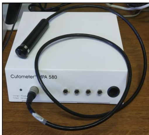
Εικόνα 17 Όργανο μέτρησης ελαστικότητας (Cutometer® MPA 580).
