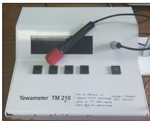
Εικόνα 14 Όργανο μέτρησης άδηλης απώλειας νερού (Tewameter® TM 240).
