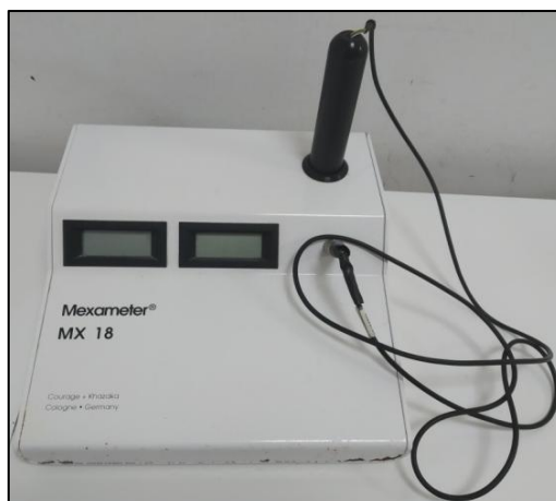
Εικόνα 16 Όργανο μέτρησης ερυθρότητας (Mexameter® MX 18).
