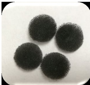
Εικόνα 60 Απορροφητικός σπόγγος 0,8 cm 2 , πάχος: 3mm
