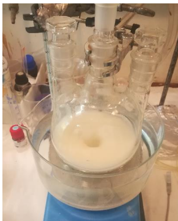
Εικόνα 12: Πρόδρομο αμινοξύ H-Phe-OH σε EtOAc πριν την προσθήκη τριφωσγενίου.
