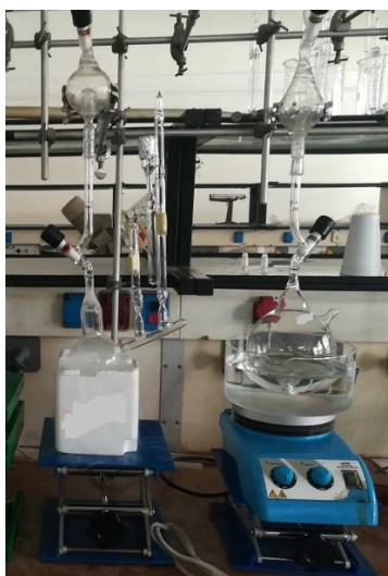
Εικόνα 17: Απόσταξη διαλύτη στην συσκευή ομοπολυμερισμού.
