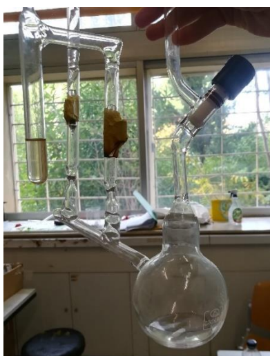
Εικόνα 18: Διάλυση του μονομερούς της φαινυλαανίνης στην αμπούλα πριν τον πολυμερισμό.
