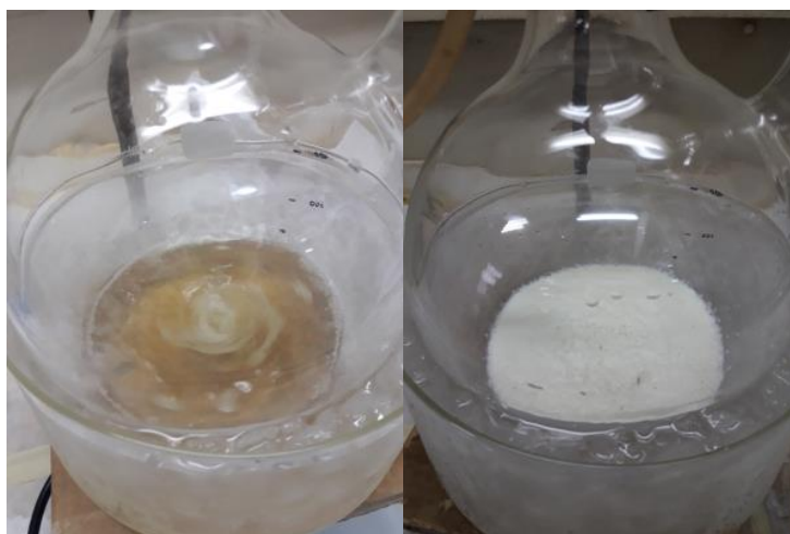
Εικόνα 15: Αριστερά: Πρόδρομο αμινοξύ Boc-His(Trt)-OH σε THF αμέσως μετά την προσθήκη \text{SOCl}_2 . Δεξιά: Μετά από 1.5 ώρα αντίδρασης προς σχηματισμό του \text{N}^{\text{im}}\text{-Trt-L-His-NCA}\cdot\text{HCl} .
