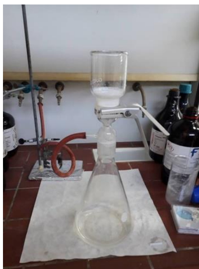
Εικόνα 20: Καταβύθιση του πολυμερούς και διήθηση υπό κενό με συσκευή διηθήσεως Buchner.
