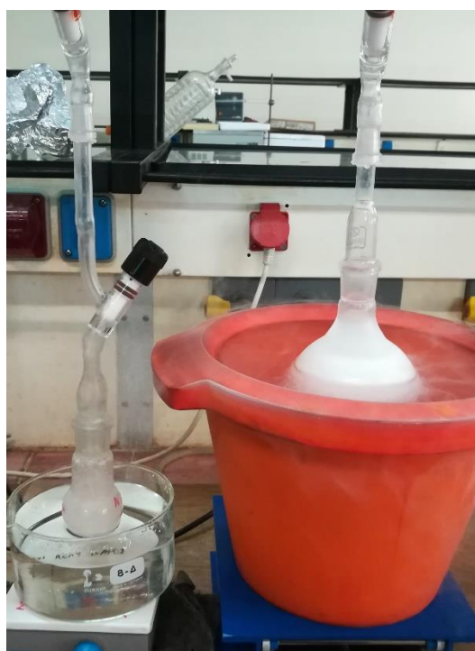
Εικόνα 22: Απομάκρυνση των διαλυτών από το πολυμερές με “short-path”.
