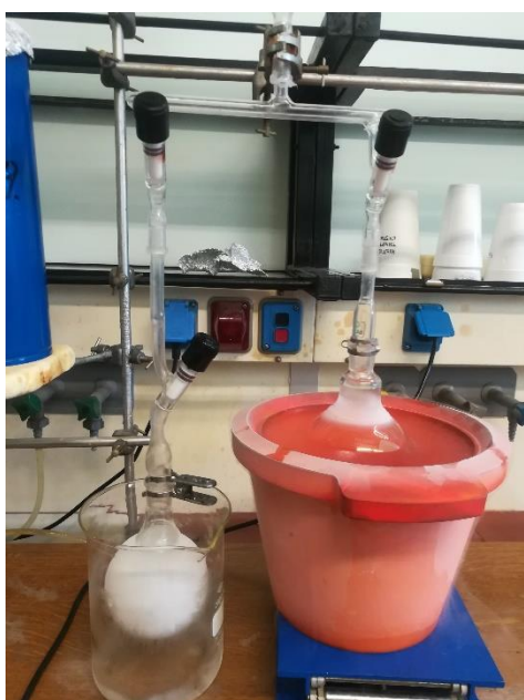
Εικόνα 24: Αριστερά η διαδικασία της λυοφιλοποίησης και δεξιά το τελικό αποπροστατευμένο πολυμερές.
