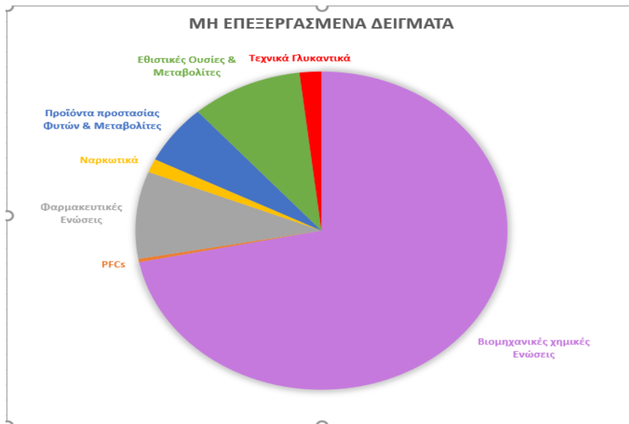
Διάγραμμα 7.2.5: Διαγραμματική απεικόνιση συνεισφοράς κάθε κατηγορίας ενώσεων . όσον αφορά στη συνολική συγκέντρωση αναδυόμενων ρύπων σε εισερχόμενα δείγματα.
