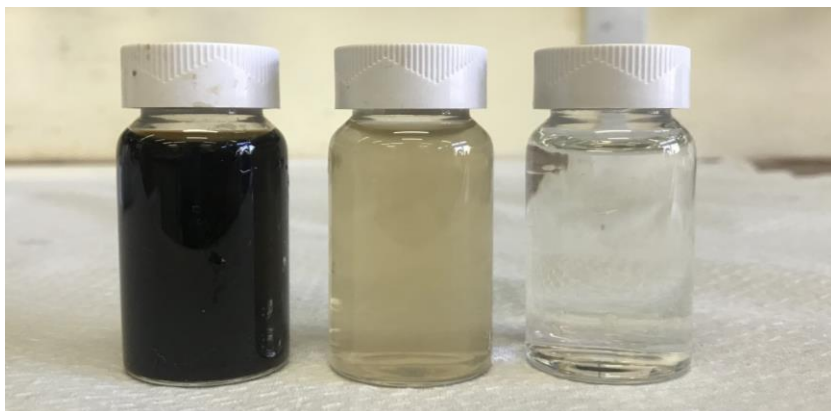
Εικόνα 1.4.1: Δείγματα Στραγγισμάτων (κατά σειρά από αριστερά) εισερχόμενα, κατά την διάρκεια της επεξεργασίας και δείγματα εξόδου.
