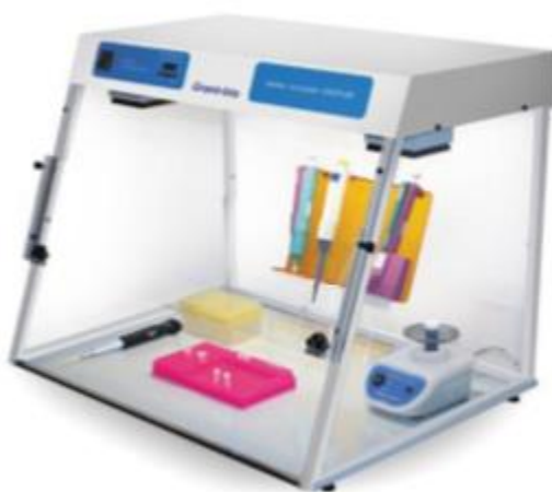
Εικόνα 6.4 Θάλαμος προετοιμασίας της αντίδρασης PCR ( https://www.biocompare.com/Lab-Equipment/21291-PCR-Workstation-PCR-Hood/ )
