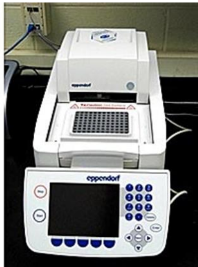
Εικόνα 6.3 Ο θερμικός κυκλοποιητής Mastercycler® ergradient
