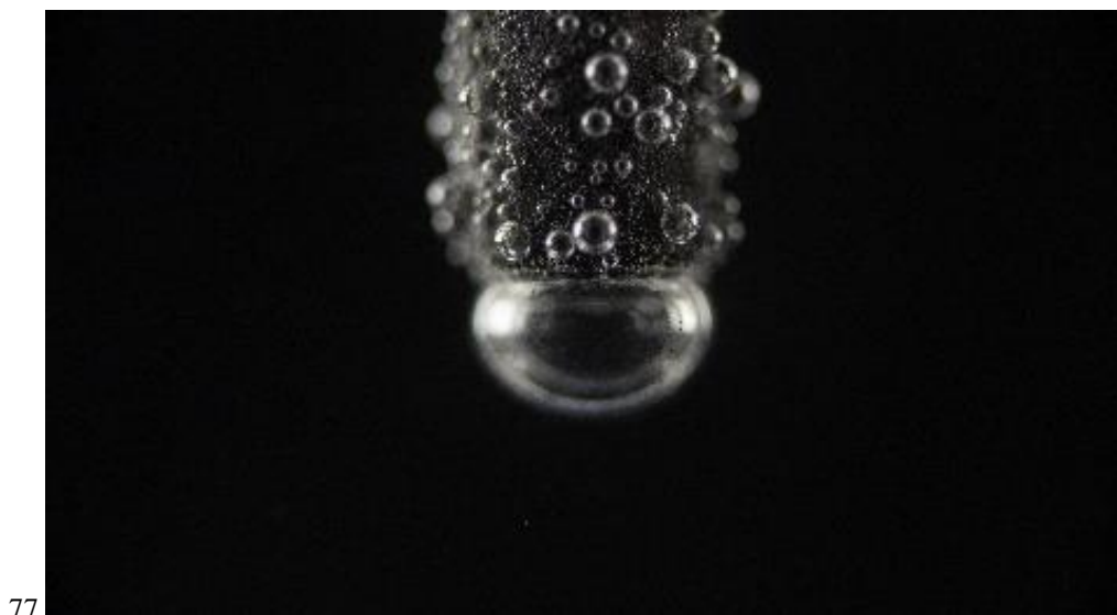
Εικ.74:Τα ηλεκτρόδια γραφίτη (άνοδος και κάθοδος). Εικ.75:Η έκλυση αερίου O_2 στην άνοδο και H_2 στην κάθοδο. Εικ.76: Η άνοδος. Εικ.77: Η κάθοδος.
