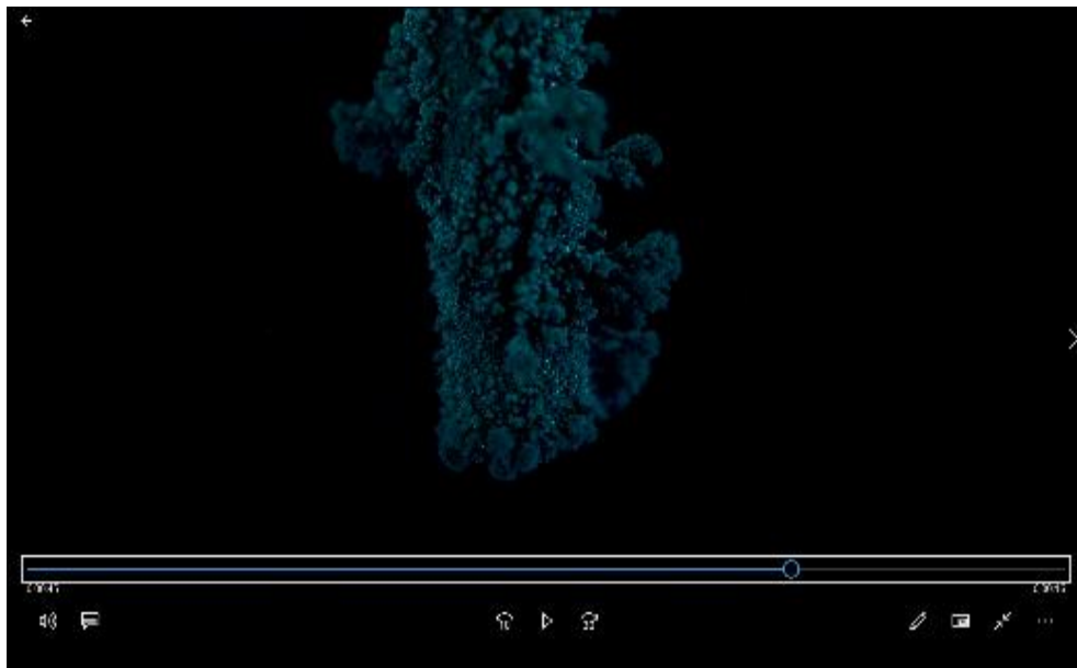
Εικ.84-87:timelapse επιχάλκωσης ενός ηλεκτροδίου γραφίτη. Snapshots από το video
