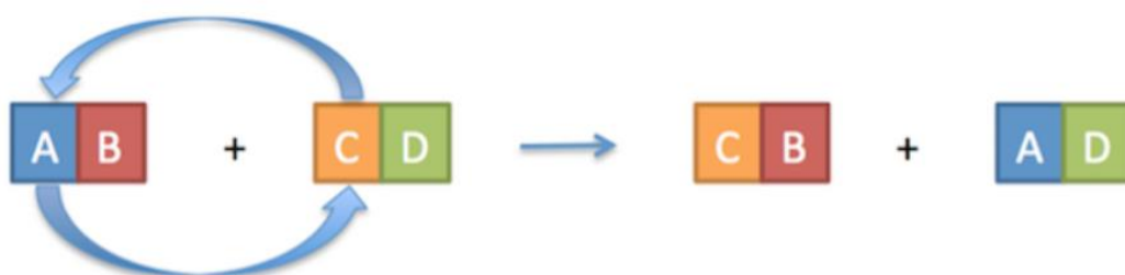
Εικ.18: Γενικό σχήμα αντιδράσεων διπλής αντικατάστασης. Τα A και C είναι κατιόντα και τα B και D ανιόντα.
