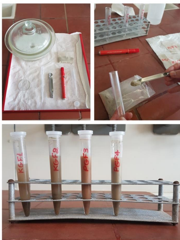
Εικόνα 18: Διαδικασία παρασκευής προσανατολισμένων δειγμάτων (Πηγή: Προσωπικό αρχείο συγγραφέων)
