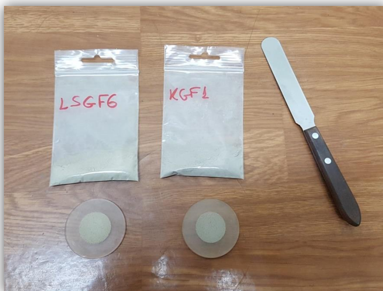
Εικόνα 17: Δείγματα μέσα στους υποδοχείς, έτοιμα για ανάλυση (Πηγή: Προσωπικό αρχείο συγγραφέων)
