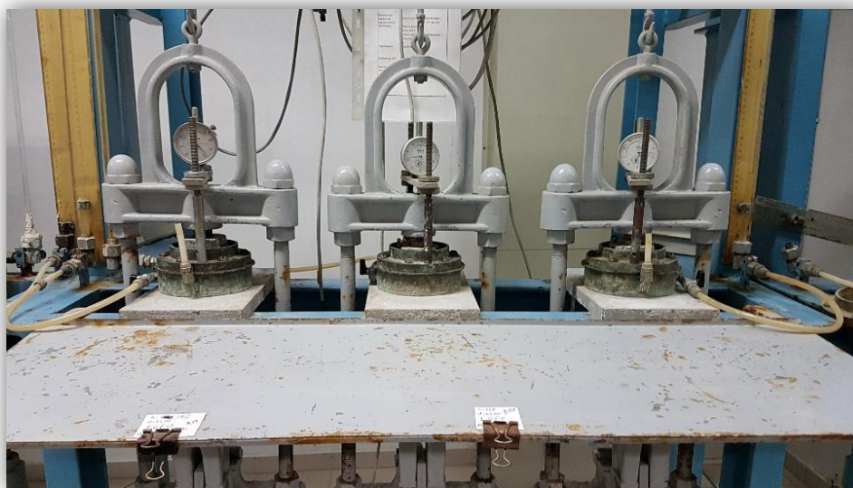
Εικόνα 28: Πειραματική διάταξη υπολογισμού διαπερατότητας (Πηγή: Προσωπικό αρχείο συγγραφέων)
