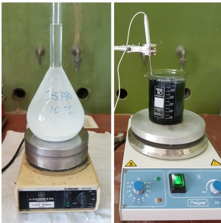
Εικόνα 20: Αριστερά διάλυμα TSPP 10%, δεξιά διάλυμα κυανού του μεθυλενίου (Πηγή: Προσωπικό αρχείο συγγραφέων)
