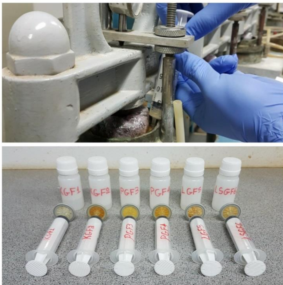
Εικόνα 31: Συλλογή διαλύματος κατά την διάρκεια του πειράματος διαπερατότητας (Πηγή: Προσωπικό αρχείο συγγραφέων)
