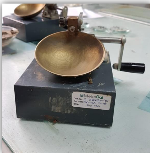
Εικόνα 22: Μηχανική συσκευή ορίου υδαρότητας (Πηγή : προσωπικό αρχείο συγγραφέων)
