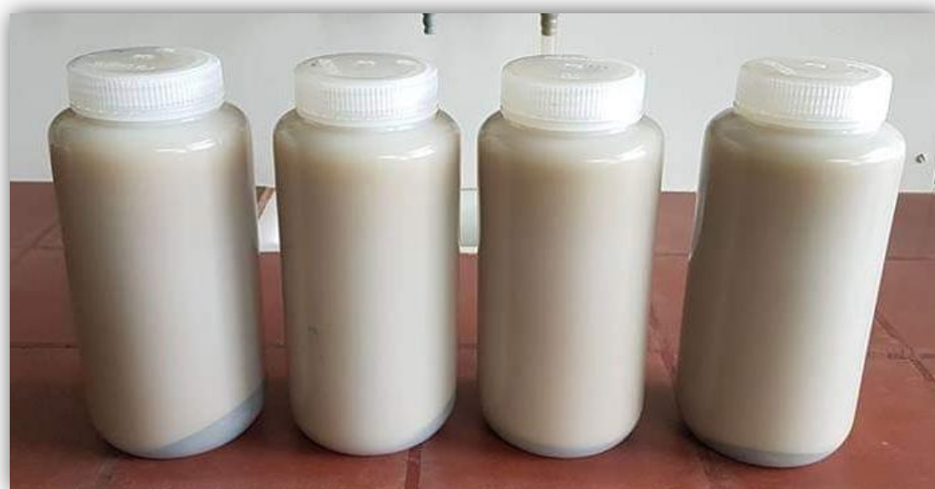
Εικόνα 30: Δοχεία 1 λίτρου με απιονισμένο νερό και έδαφος με αναλογία 10:1 (Πηγή: Προσωπικό αρχείο συγγραφέων)
