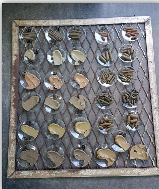
Εικόνα 23: Ποσότητα υλικού για τον υπολογισμό ορίων υδαρότητας και πλαστικότητας (Πηγή: Προσωπικό αρχείο συγγραφέων)
