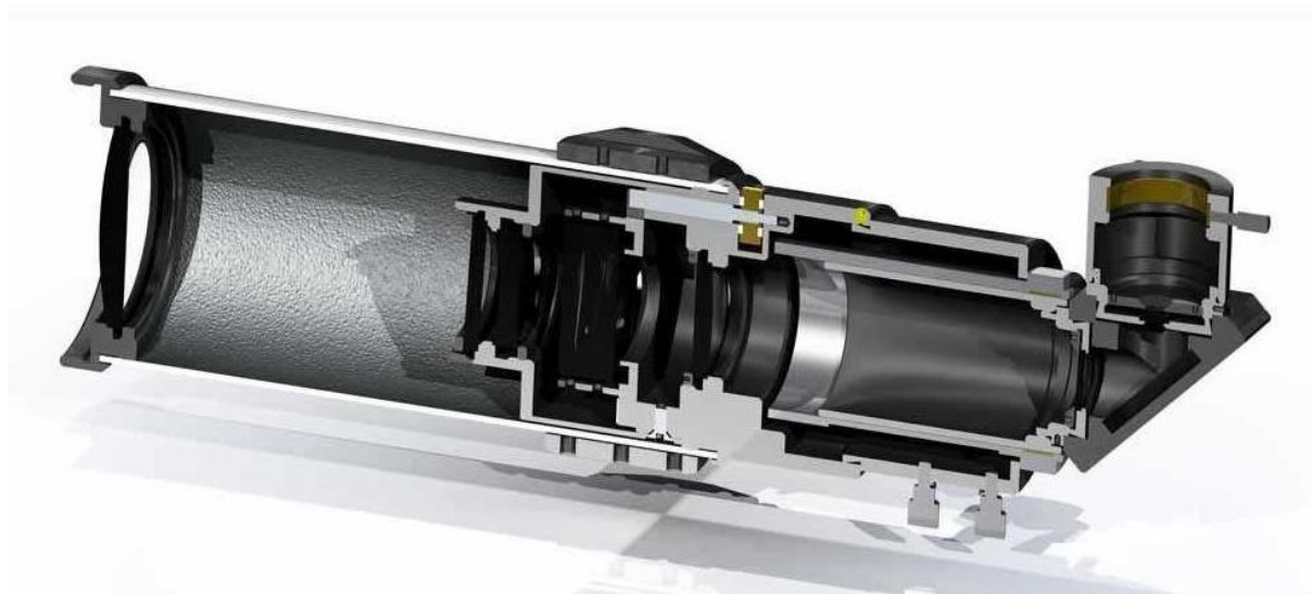
Σχήμα 4.3: Εσωτερική δομή ενός τυπικού τηλεσκοπίου της Lunt. Αρχής γενομένης από τον φακό και οδεύοντας προς τον παρατηρητή, διακρίνονται ο αχρωματικός φακός, το εσωτερικό Etalon και το ανακλαστικό φίλτρο.
