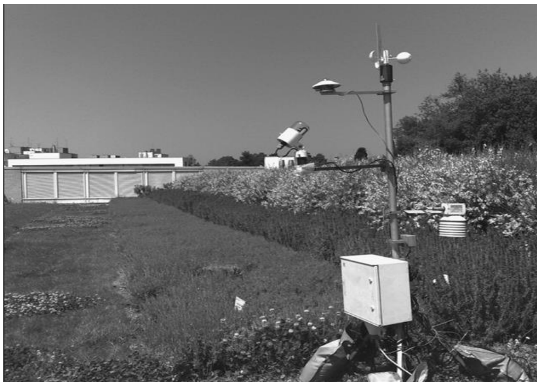
Εικόνα 2.11: Μετρήσεις μετεωρολογικών παραμέτρων πάνω σε πράσινη οροφή κτιρίου στη περιοχή της Αγκόνα, Ιταλία (Fioretti et.al, 2010).
