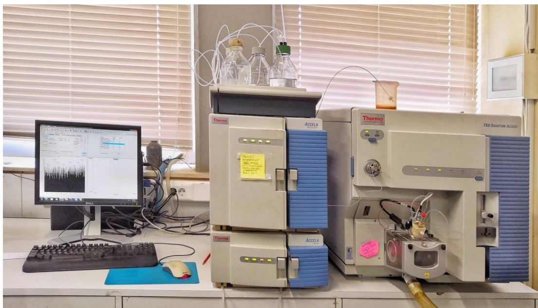
Σχήμα 10 Υγροχρωματογραφικό σύστημα με ανιχνευτή φασματομετρίας μαζών με τριπλό τετράπολο (LC-MS/MS) της Thermo Scientific Quantum.
