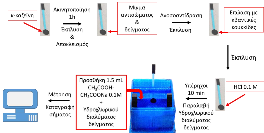
Εικόνα 12: Σχηματική αναπαράσταση πρωτοκόλλου για τον προσδιορισμό νοθείας αιγοπρόβειου τυριού με αγελαδινό στον ηλεκτροχημικό ανοσοαισθητήρα
