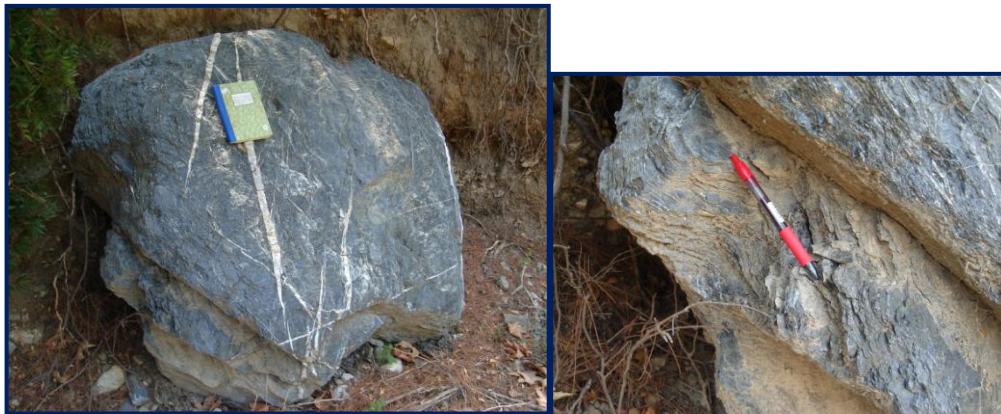
Εικόνα 41. Στην όχθη του διανοιγμένου ρέματος υπάρχει βράχος διαστάσεων 1 m x 1.20 m x 0.50 m, στον οποίο διακρίνεται έντονη φύλλωση. Το γκρι-μαύρο χρώμα του υποδεικνύει οργανική ύλη ή υπερβασικό πρωτόλιθο που υπέστη έντονη μεταμόρφωση και παραμόρφωση. Οι λευκές φλέβες τέμνουν κάθετα τις επιφάνειες φύλλωσης και πληρούνται με ασβεστίτη. Το φυλλωμένο υλικό του είναι εύθρυπτο, ενώ μοιάζει με το υλικό πετρωμάτων που απαντώνται στο Βελανιό. Φωτογράφιση του 2016.
