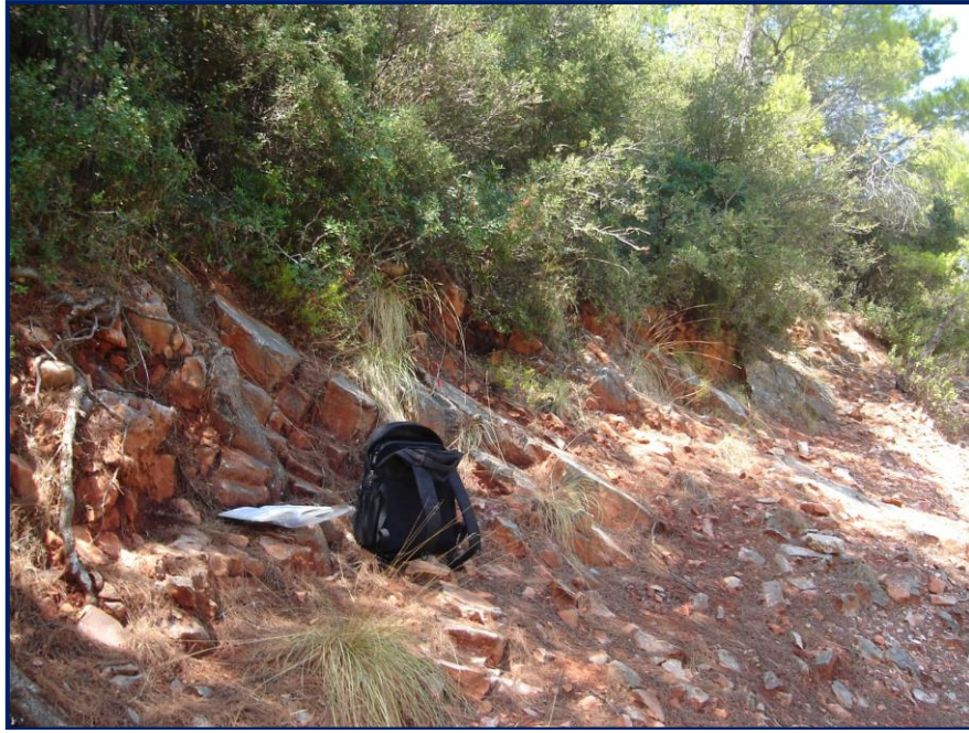
Εικόνα 52. Χαρακτηριστικές επιφάνειες κυρίων διακλάσεων στην εμφάνιση των Ανωκρητιδικών ασβεστολίθων, 10 m Νότια της Εικ. 51. Μετρήσεις των στοιχείων σε 3 τέτοιες επιφάνειες έδωσαν ως μέση τιμή: 30/030.
