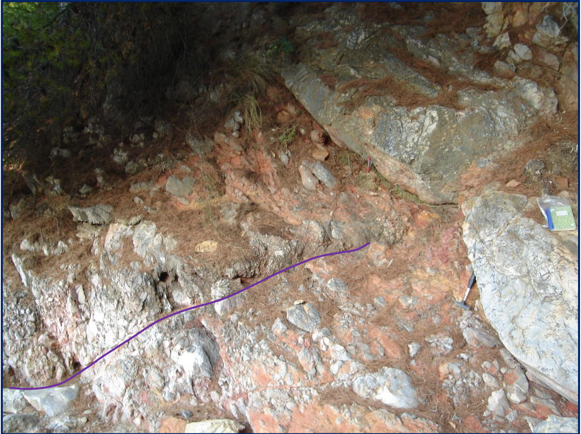
Εικόνα 157. Η εμφάνιση της επαφής που υπάρχει στην Εικ. 156 από κοντά. Τα στοιχεία μιας χαρακτηριστικής κατακλαστικής επιφάνειας (μωβ γραμμή) είναι: 45/340.
