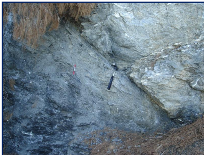
Εικόνα 92. Περίπου 20 m δυτικά της πτυχής της Εικόνας 89, συναντάμε μια επαφή με υπερκείμενα τα σκουρόχρωμα γκρι σχιστοποιημένα και πτυχωμένα πετρώματα, που εδώ είναι αρκετά σκληρά (αργιλικά με ενδιστρώσεις ασβεστολίθων πάχους 0,5-3 cm). Υποκείμενο είναι ένα μαύρο σχιστοποιημένο/φυλλωμένο και σχετικά εύθρυπτο πέτρωμα (μεταβασικό?), το οποίο εμφανίζεται και σε άλλες θέσεις δυτικότερα, προς την πλευρά του ακρωτηρίου Στάφυλος. Η επιφάνεια επαφής έχει στοιχεία: 60/050. Στο υποκείμενο μαύρο πέτρωμα μετρήθηκαν τα εξής στοιχεία μιας χαρακτηριστικής επιφάνειας σχιστότητας: 35/020.
