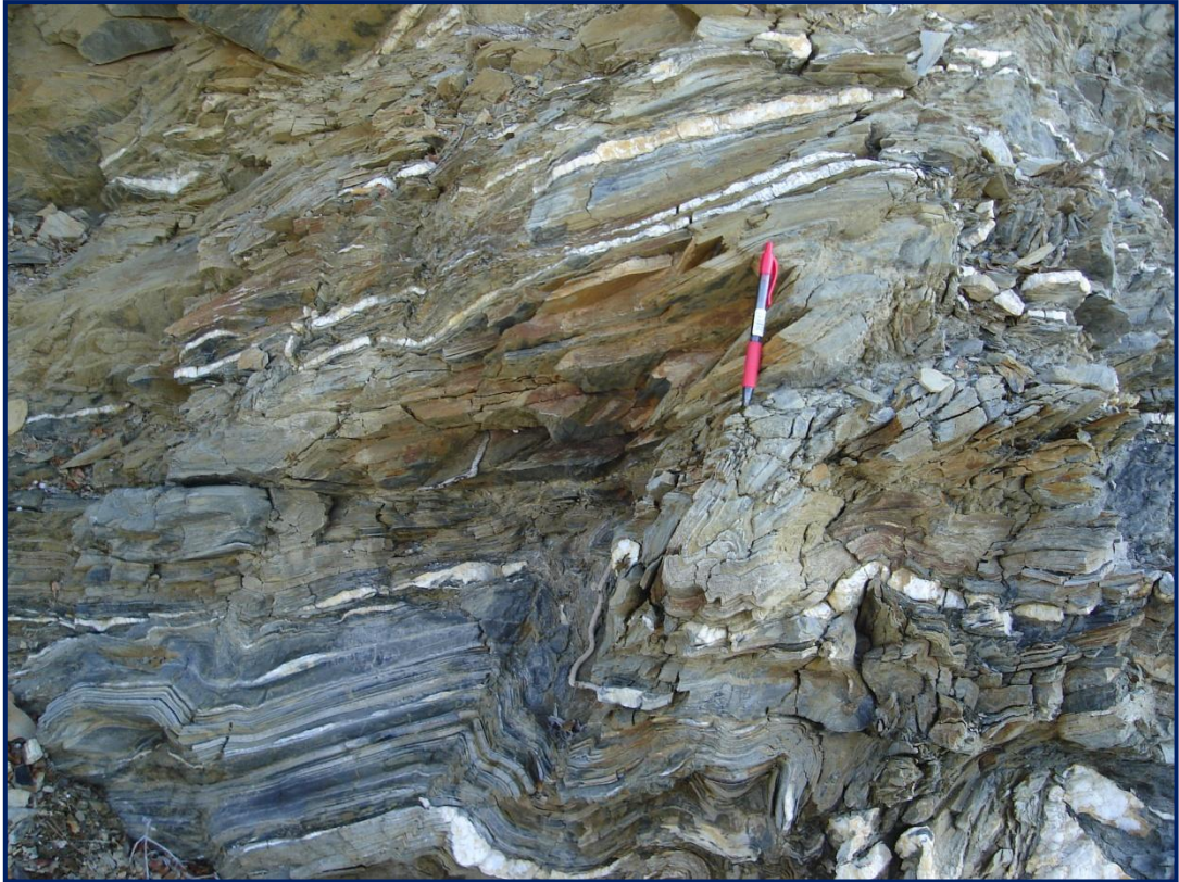
Εικόνα 142. Λεπτομέρεια από την εμφάνιση της Εικόνας 141. Η πτυχή κάτω από το στυλό έχει αξονικό επίπεδο με στοιχεία: 40/340.
