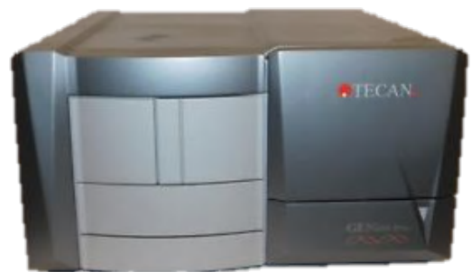
Εικόνα 7. Αναλυτής μικροπλακών Genios Pro της εταιρίας TECAN, Austria.
