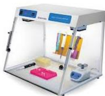
Σχήμα 4.6: Θάλαμος προετοιμασίας των αντιδράσεων PCR
