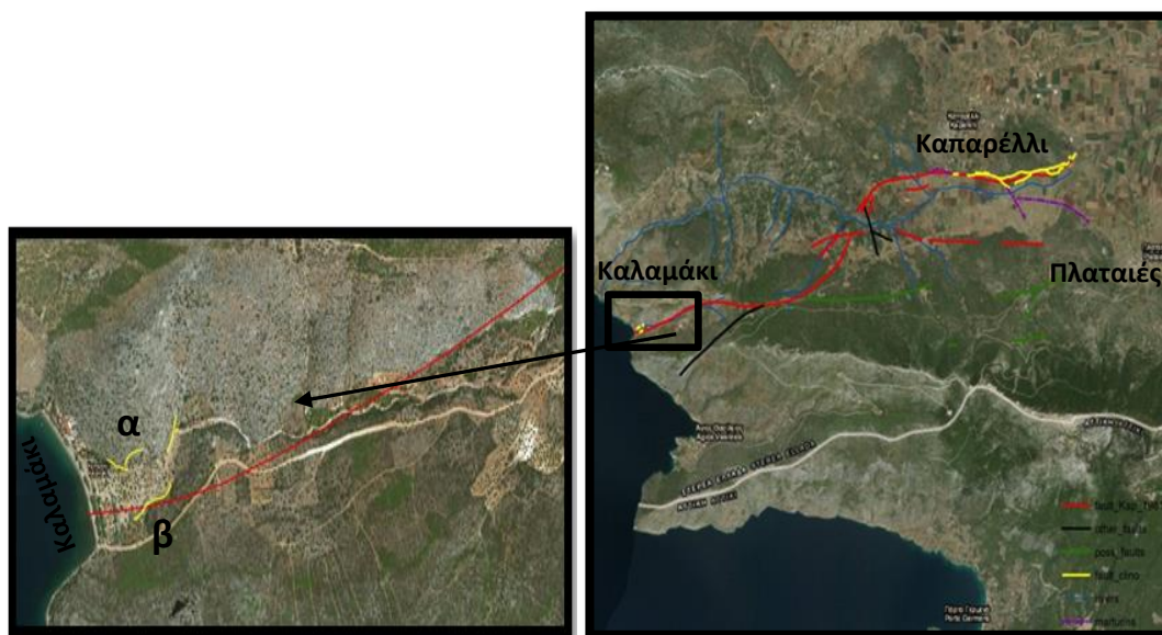
Εικόνα 39. Το Νότιο τμήμα του ρήγματος του Καπαρελλίου. Με τη κόκκινη γραμμή παρουσιάζεται η χαρτογραφημένη πορεία της διάρρηξης του ρήγματος κατά την περίοδο 1981, ενώ με κίτρινο αποτυπώνεται η επιφάνεια του ρήγματος εκεί που βρίσκεται σήμερα. Οι κίτρινες γραμμές που βρίσκονται στη πλευρά “α”, αποτελούν το ίχνος του ρήγματος του Καπαρελλίου, δηλαδή το Νότιο τμήμα του ρήγματος, ενώ η κίτρινη γραμμή που βρίσκεται στην πλευρά “β”, αντιπροσωπεύει το ίχνος ενός αντιθετικού ρήγματος που κλίνει προς βορρά, αντίθετα δηλαδή από ότι κλίνει το ρήγμα του Καπαρελλίου.
