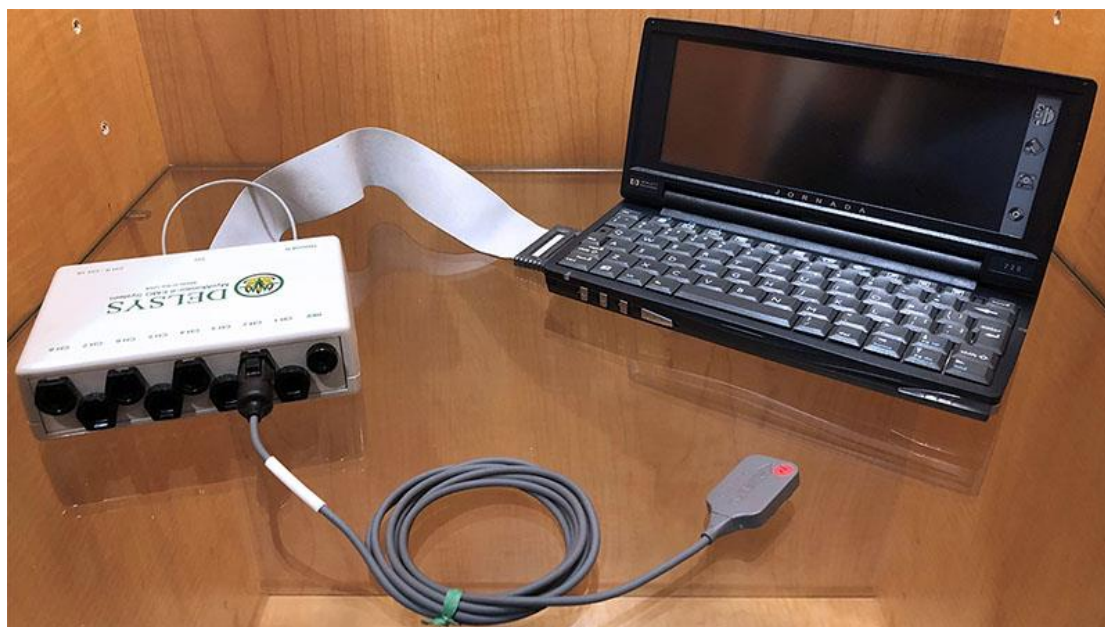
Ηλεκτρομυογράφος Delsys DS-U05 Wireless Myomonotir Trigger Module
