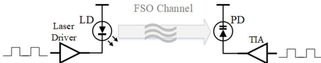
Σχήμα 6.1. Απεικόνιση πομπού, δέκτη και ατμοσφαιρικού καναλιού για σύστημα FSO με διαμόρφωση OOK.
