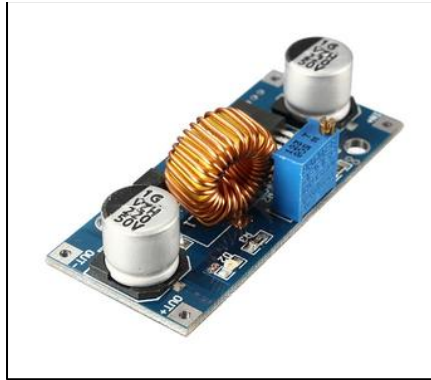
Εικόνα 3.9. Ο υποβιβαστής τάσης XL4005 [Πηγή: https://www.cableworks.gr/images/thumbnails/343/300/detailed/3/XL4005.jpg ]
