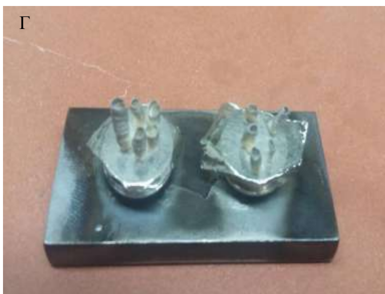
Εικόνα 10 (Α,Β,Γ): Προετοιμασία δειγμάτων για επιχρύσωση και απεικόνιση της διαδικασίας.
