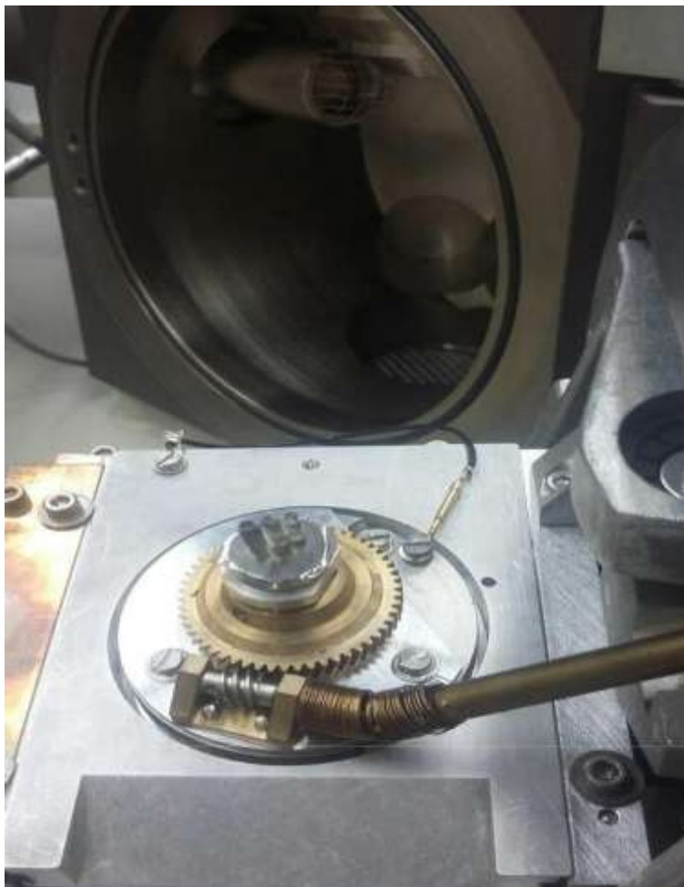
Εικόνα 11: Τοποθέτηση των δειγμάτων ιστού τραχείας στο ηλεκτρονικό μικροσκόπιο σάρωσης για παρατήρηση.
