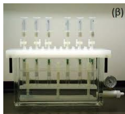
Σχήμα 5.1. (α) Σωλήνες-μικροστήλες SPE, (β) Συσκευή κενού, ταυτόχρονου χειρισμού πολλών στηλών SPE [34].
