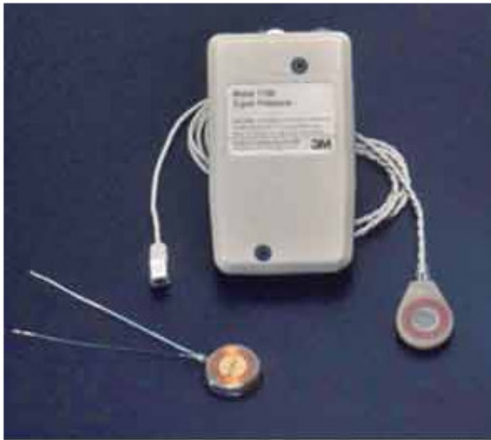
Εικόνα-30: Το σύστημα εμφυτεύματος-εξωτερικού επεξεργαστή της 3M/ House που εγκρίθηκε από το FDA το 1984 για χρήση σε ενήλικες [House Research Institute, 2012]
