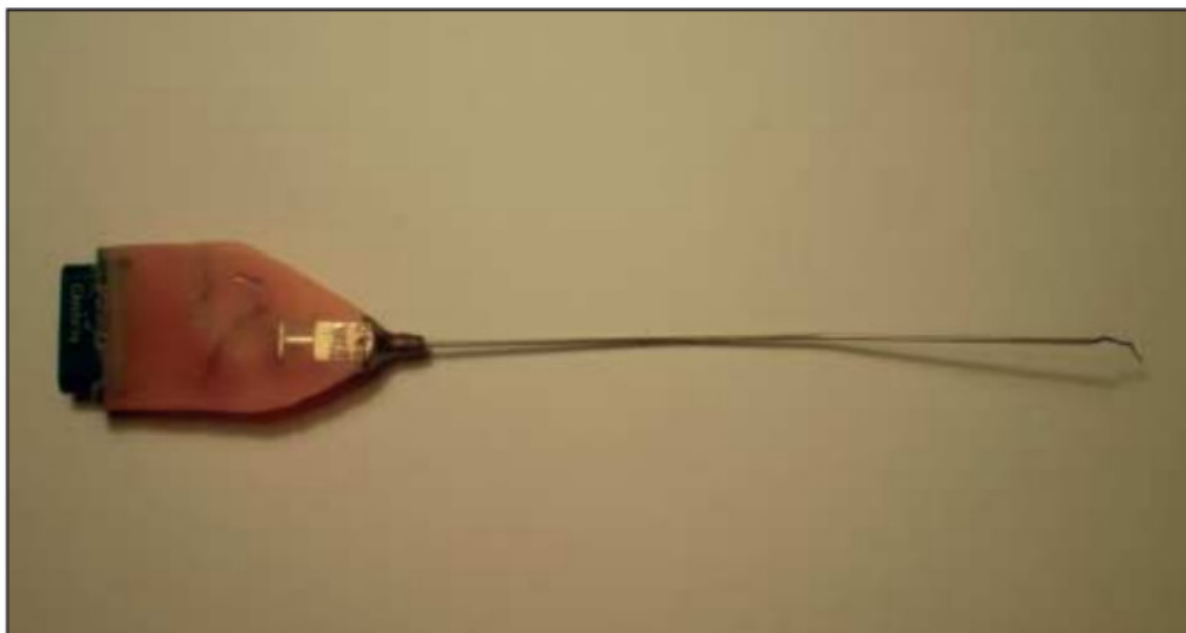
Εικόνα-12: Το πρωτότυπο εμφύτευμα του House και Doyle [Mudry et Mills, 2013]
