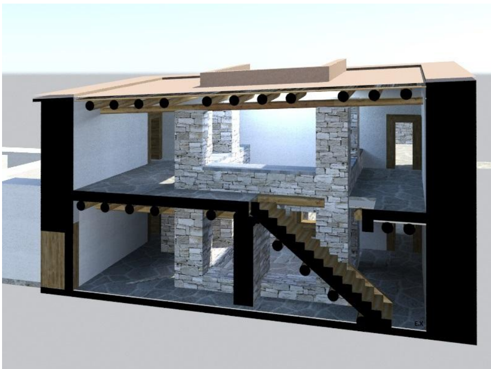
12β. Ψηφιακή αναπαράσταση συγκροτήματος Χώρων 19-28-49 με επιχρισμένους τοίχους. Φωτορεαλιστική απεικόνιση του εσωτερικού σε τομή.
