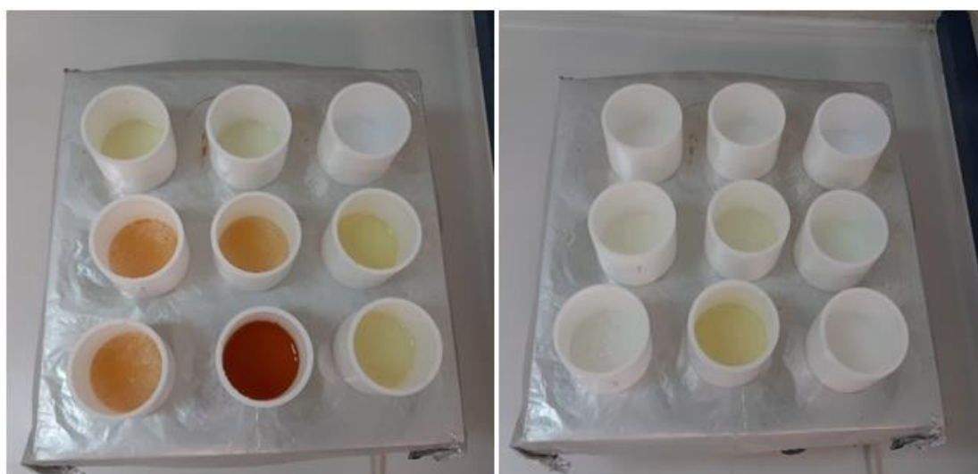
Εικόνα 16: Στάδια αποχρωματισμού της οργανικής ύλης κατά τη διαδικασία της χώνευσης στα Teflon επί της θερμαντικής πλάκας.
