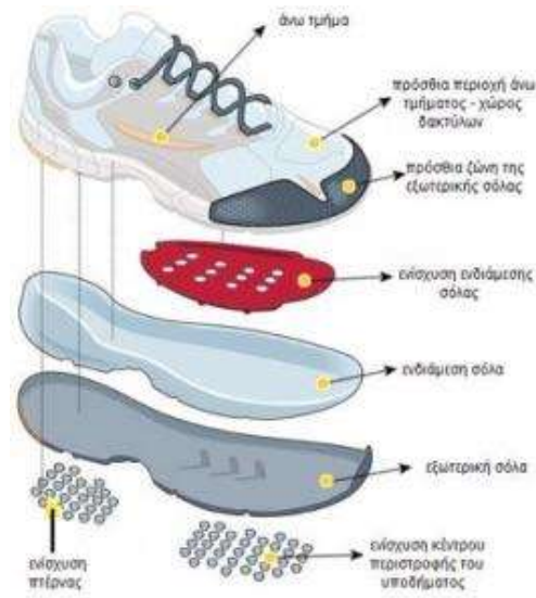
Εικόνα 2.2.10. Το κάτω μέρος του αθλητικού υποδήματος ( https://www.arthroathens.gr/%CE%BB%CE%AF%CE%B3%CE%B1-%CE%BB%CF%8C%CE%B3%CE%B9%CE%B1-%CE%B3%CE%B9%CE%B1-%CF%84%CE%BF-%CE%B1%CE%B8%CE%BB%CE%B7%CF%84%CE%B9%CE%BA%CF%8C-%CF%80%CE%B1%CF%80%CE%BF%CF%8D%CF%84%CF%83%CE%B9/ )
