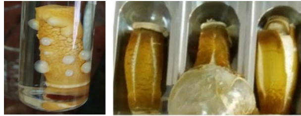
Εικόνα 5: Πηκτώμα PNBD/PDCPD (FL2) με το καταλυτικό σύστημα W_2 σε αναλογία mol W_2 /NBD/DCPD: 1/250/250 (αριστερά). Πηκτώματα PNBD/PDCPD (FL2) μετά από ξήρανση με χρήση του καταλυτικού συστήματος W_2 σε αναλογία mol W_2 /NBD/DCPD: 1/250/250 (δεξιά).
