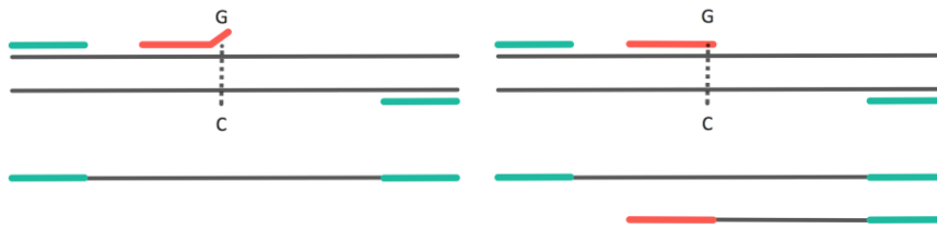
Εικόνα 11. Βασική αρχή της μεθόδου AS-PCR. Αριστερά: Απουσία μετάλλαξης συντίθενται μόνο ένα προϊόν που αφορά στη ζώνη θετικού ελέγχου. Δεξιά: Όταν υπάρχει μετάλλαξη, τότε αναδεικνύονται δύο προϊόντα κατά την ηλεκτροφόρηση της αντίδρασης σε πηκτή αγαρόζη, η ζώνη θετικού ελέγχου, καθώς και ένα μικρότερο προϊόν, ειδικό του πολυμορφισμού.
