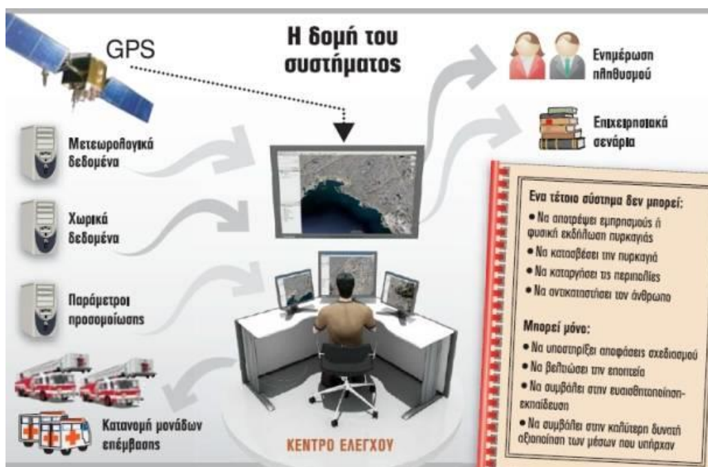
Εικόνα 19 : Η δομή συστήματος πρόληψης
