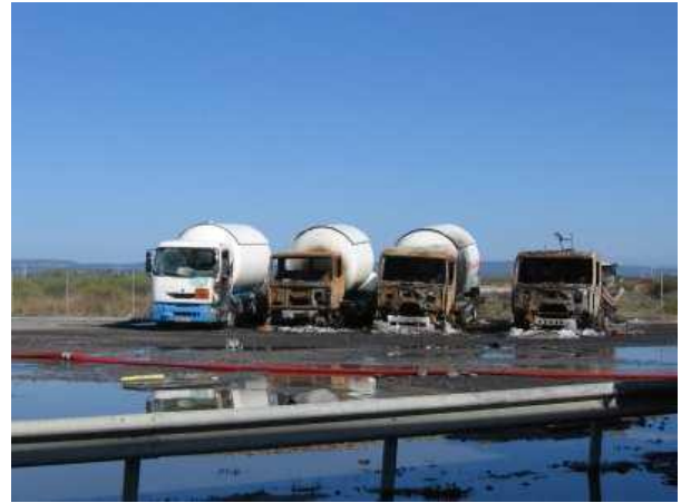
Εικόνα 5.13. Οι υλικές ζημιές που προκλήθηκαν στα διπλανά κτίρια της εγκατάστασης και στα σταθμευμένα βυτιοφόρα (BARPI, 2013).
