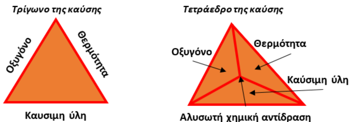
Εικόνα 4.4. Σχηματική απεικόνιση του τριγώνου και του τετράεδρου της καύσης (Πυροσβεστικό Σώμα Ελλάδας, 2009)
