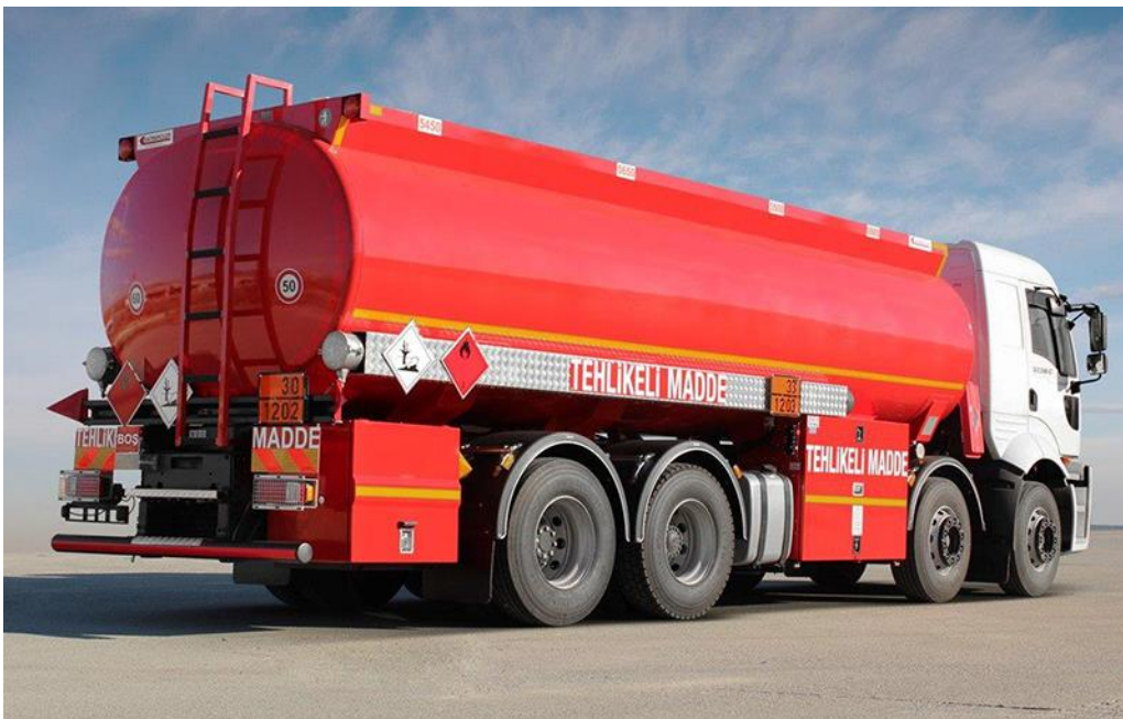
Εικόνα 3.7. Παράδειγμα βυτιοφόρου που φέρει πινακίδες κινδύνου σε πτυσσόμενα πάνελ (katmerciler).
