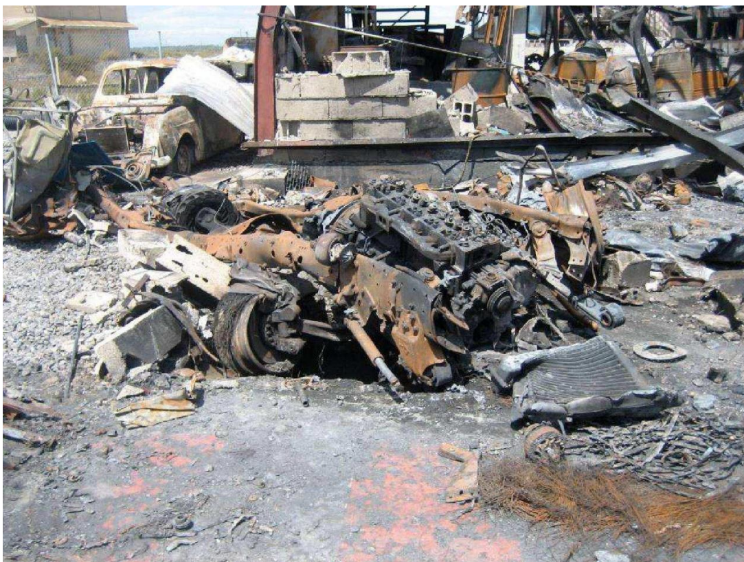
Εικόνα 5.11. Το κατεστραμμένο βυτιοφόρο μετά την έκρηξη BLEVE (BARPI, 2013).
