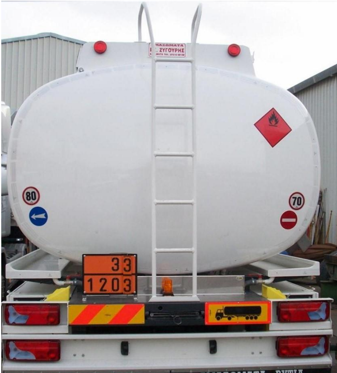
Εικόνα 3.2. Παράδειγμα βυτιοφόρου που φέρει πορτοκαλί πινακίδα σήμανσης με εναλλάξιμους αριθμούς (το τελευταίο ψηφίο του αριθμού αναγνώρισης κινδύνου και του αριθμού UN) (zygouris)
