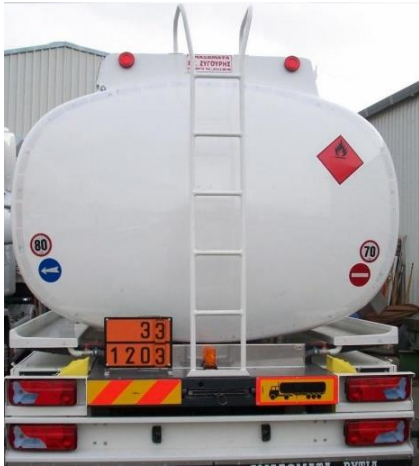
Εικόνα 3.6. Παράδειγμα τοποθέτησης ετικετών κινδύνου σε βυτιοφόρο όχημα μεταφοράς εύφλεκτων ουσιών (zygouris).
