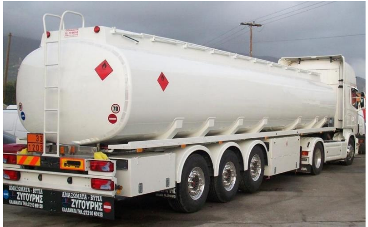
Εικόνα 3.6. Παράδειγμα τοποθέτησης ετικετών κινδύνου σε βυτιοφόρο όχημα μεταφοράς εύφλεκτων ουσιών (zygouris).
