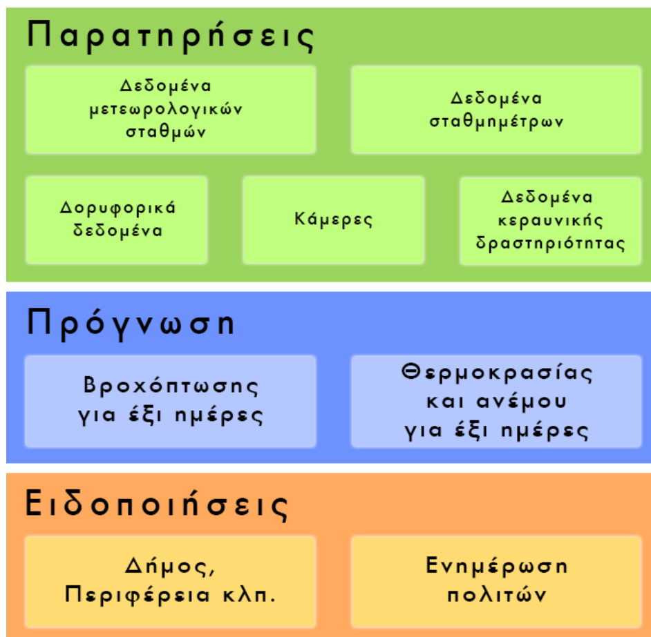
Εικόνα 3.21: Η δομή του Ολοκληρωμένου Συστήματος Ενημέρωσης και Προειδοποίησης που θα υλοποιηθεί από την ΔΕΥΑ Κιλκίς και το Εθνικό Αστεροσκοπείο Αθηνών (ΕΑΑ).
