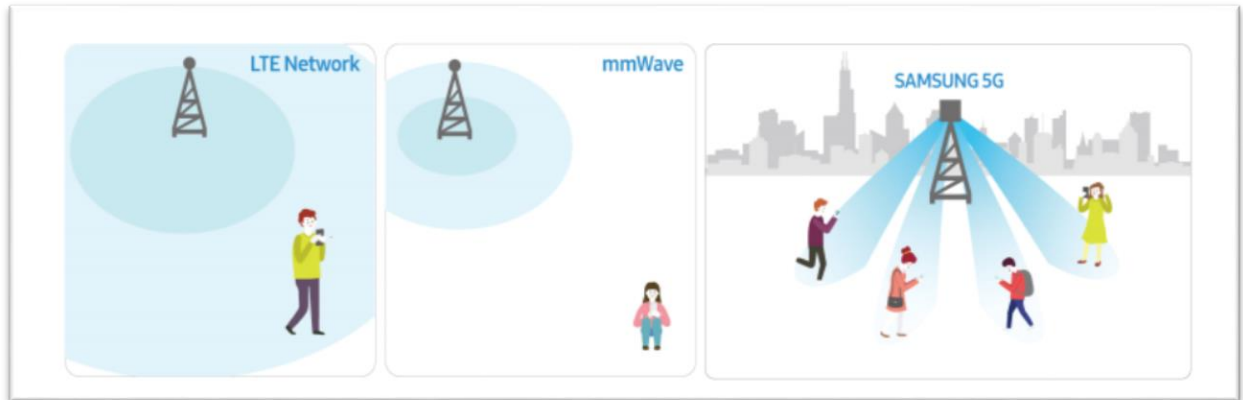
Εικόνα 10: Πώς λειτουργεί η τεχνολογία σχηματισμού ακτινών(Beamforming)
