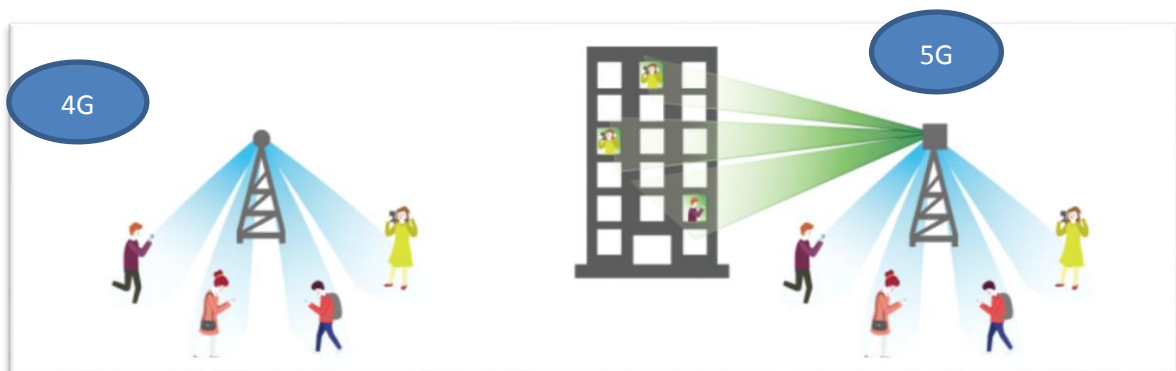
Εικόνα 11: Πως λειτουργεί η τεχνολογία MIMO-4Gvs 5G
