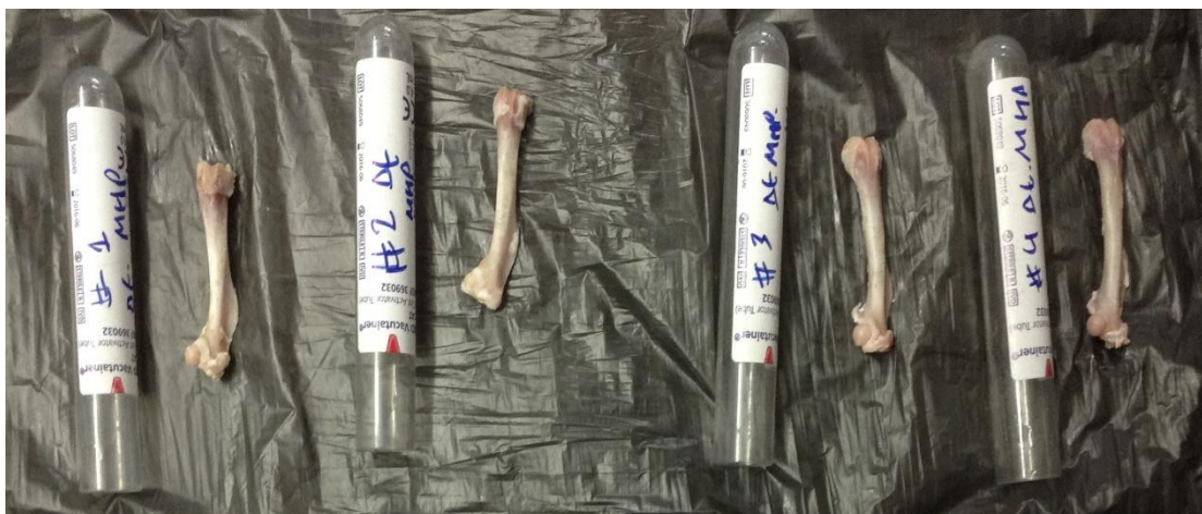
Εικόνα 23 Τα μηριαία απελευθερώνονται από τις συνθήκες διατήρησής τους και επανέρχονται σε θερμοκρασία δωματίου πριν τη δοκιμασία μηχανικής αντοχής.
