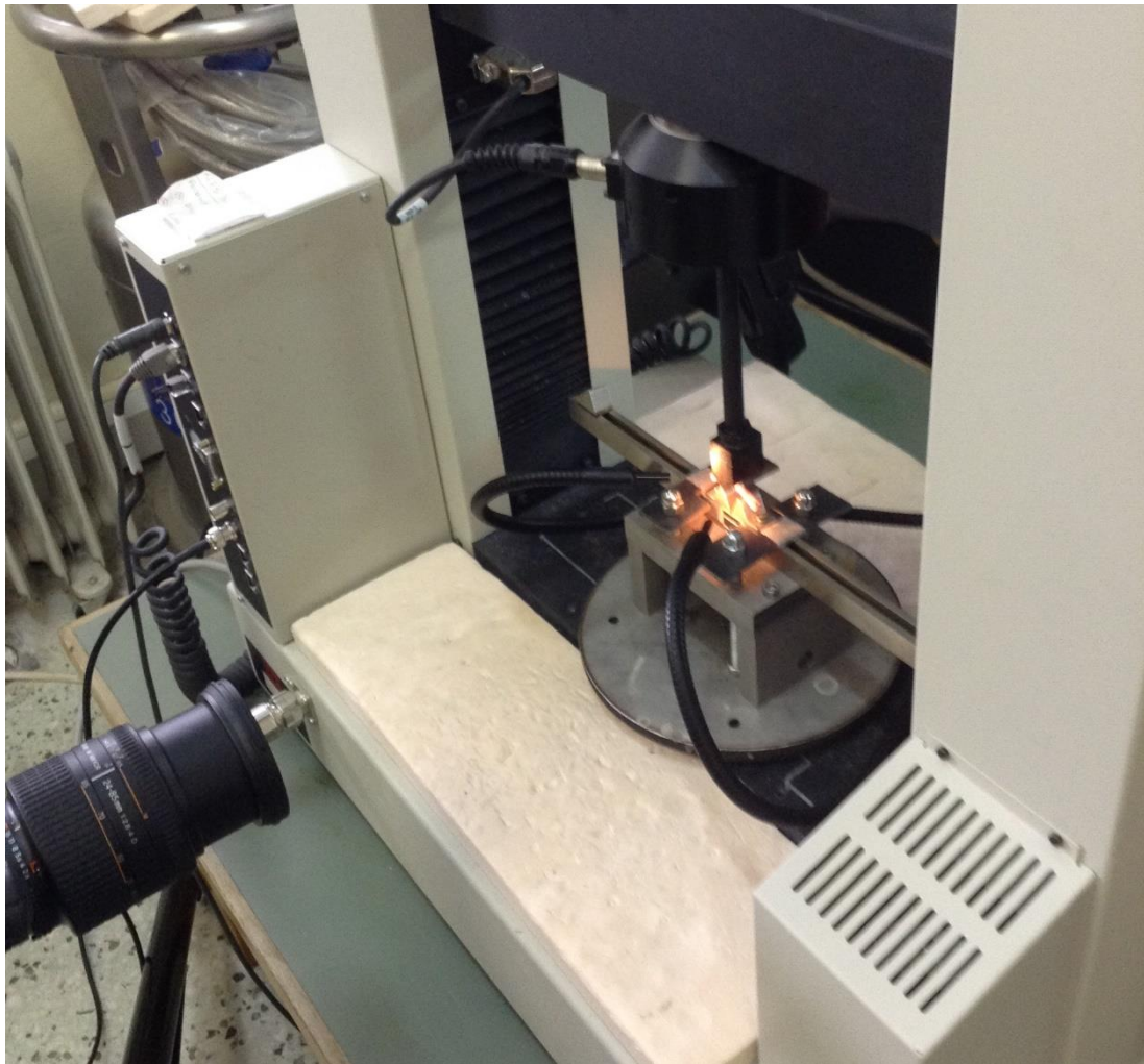
Εικόνα 25 Το έμβολο ξεκινά σε απόσταση απ' το οστό με ρυθμό 1mm/min, μέχρι να το ακουμπήσει και να αρχίσει το γράφημα να διαμορφώνεται από τις πληροφορίες εφαρμοζόμενης δύναμης και χρόνου.
