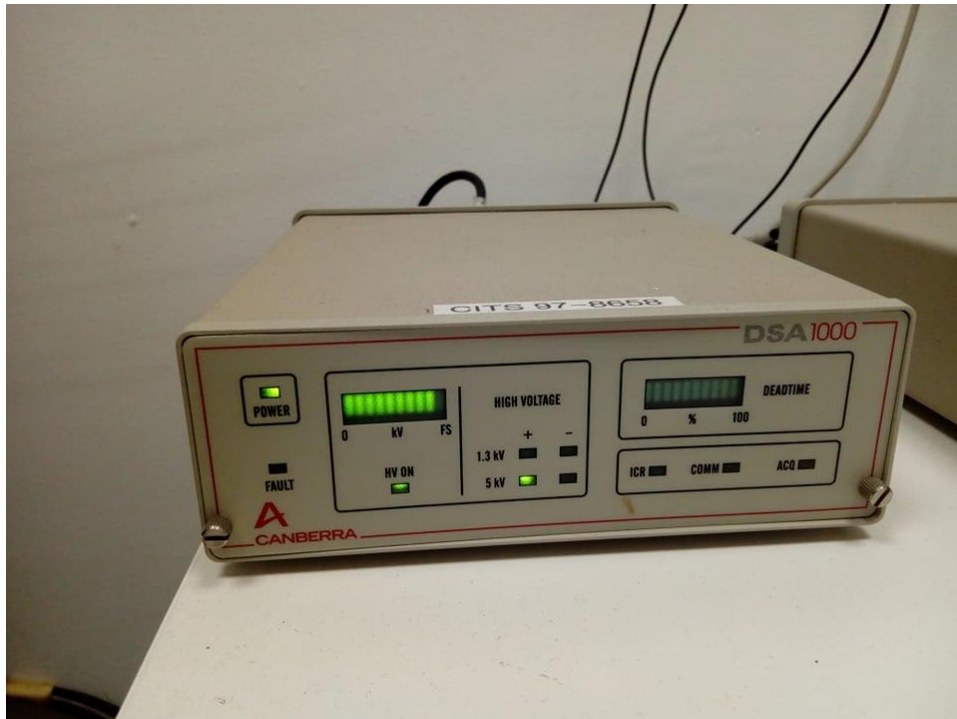
Εικόνα 2.2 Φωτογραφία εξοπλισμού επεξεργασίας ψηφιακού σήματος (DSA).
