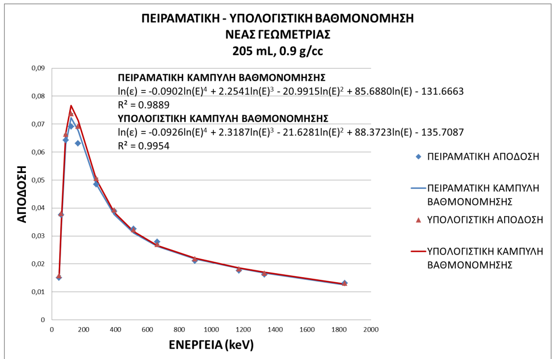
Διάγραμμα 4.22 Διεξαγωγή μεθόδου μεταφοράς απόδοσης για το κιάθιο νέας γεωμετρίας, όγκου πλήρωσης 205 mL και πυκνότητας 0.9 g/cc.
