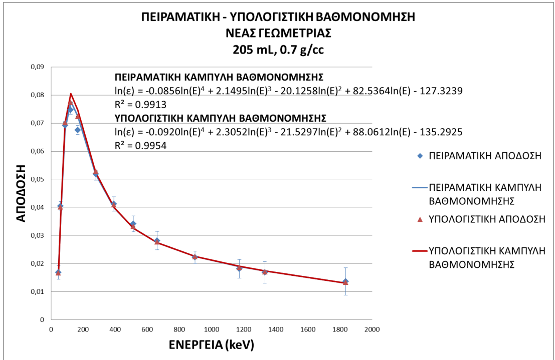
Διάγραμμα 4.21 Διεξαγωγή μεθόδου μεταφοράς απόδοσης για το κιάθιο νέας γεωμετρίας, όγκου πλήρωσης 205 mL και πυκνότητας 0.7 g/cc.
