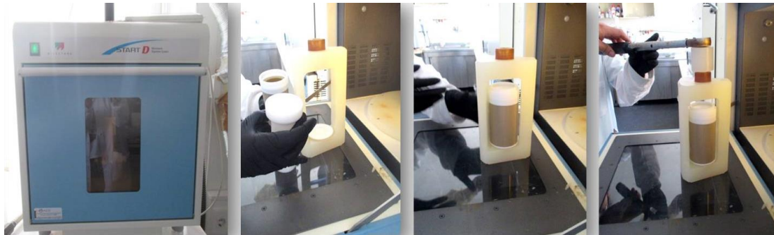
Εικόνα 4.3-3: Τα φιαλίδια σφραγίστηκαν και τοποθετήθηκαν σε φούρνο μικροκυμάτων για τη χώνευση
