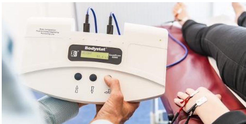
ΕΙΚΟΝΑ 2.2.1 ΜΗΧΑΝΗΜΑ ΠΟΛΥΣΥΧΝΟΤΙΚΗΣ ΕΜΠΕΔΗΣΗΣ QUADSCAN 4000 ΤΗΣ BODYSTAT ( https://www.hva.nl/urban-vitality/onderzoek/livings-labs/anac/mf-bia/mf-bia.html )
