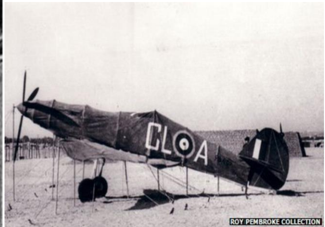
Εικόνα 2.31 Εικονικό Αεροσκάφος. Το συγκεκριμένο Hawker Hurricane δεν είναι από περιοχή της Μ. Βρετανίας αλλά από την Αφρική καθώς η χρήση ψεύτικων μέσων για την παραπλάνηση της αντίπαλης πλευράς διαδόθηκε εξαιτίας των σημαντικών αποτελεσμάτων. XXII
