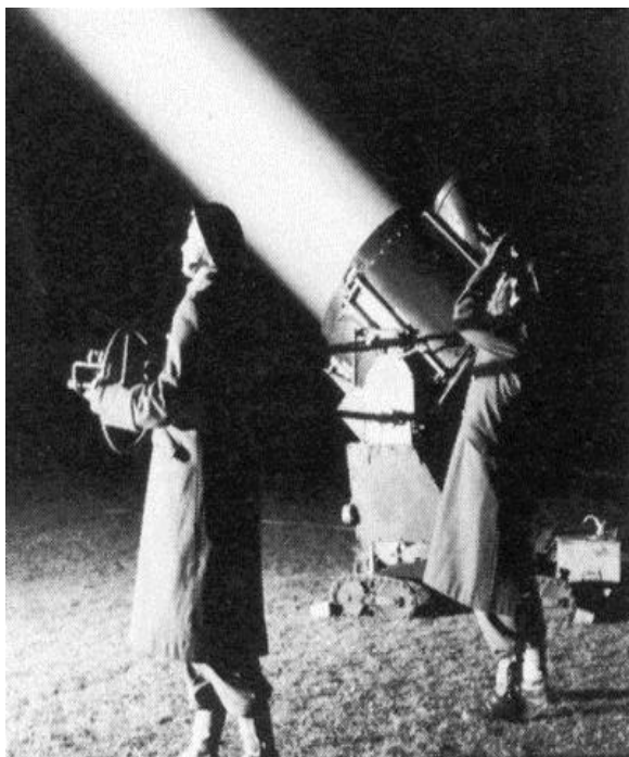
Εικόνα 2.28 Ανιχνευτικός Προβολέας. Μέχρι και το τέλος του Β' ΠΠ έπαιξαν κύριο ρόλο στον εντοπισμό των εχθρικών αεροσκαφών κατά την διάρκεια νυχτερινών επιθέσεων και μέχρι την τοποθέτηση RADAR στα καταδιωκτικά αεροσκάφη. xxx1
