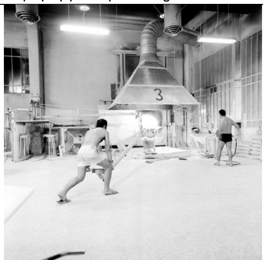
Επισμάλτωση χυτοσιδηρού λουτήρα. Οι εργάτες είναι γυμνοί, λόγω της αποπνικτικής ζέστης
