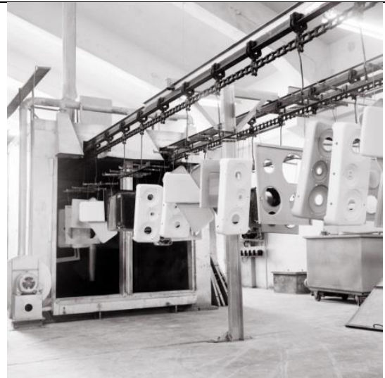
Τμήματα ηλ. κουζίνας σε σύστημα μεταφοράς προς τον φούρνο επισμάλτωσης
