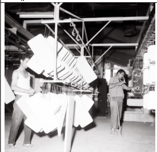
Επισμάλτωση χωρίς πιστόλι σε πόρτες λευκών συσκευών
