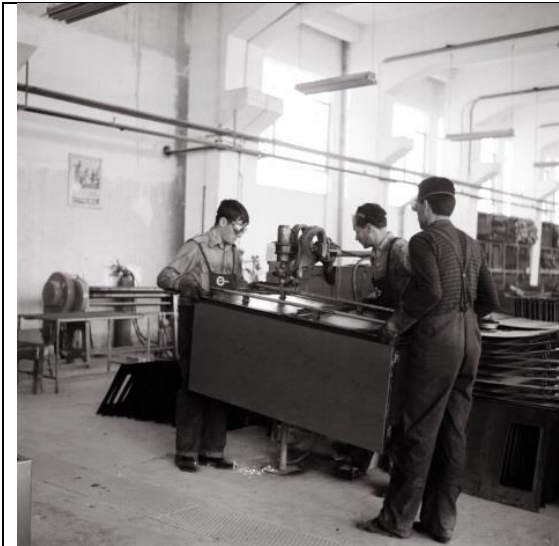
Ποντάρισμα (συγκόλληση) σε πόρτα ψυγείου
