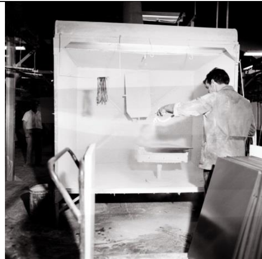
Ηλεκτροθετική επισμάλτωση χωρίς πιστόλι
