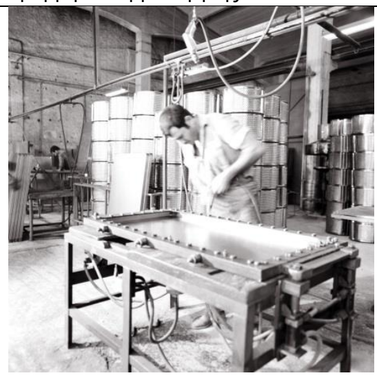
Καλούπι πόρτας ψυγείου (με αναρρόφηση)
