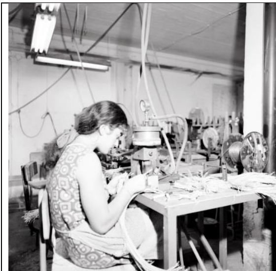
Συναρμολόγηση καλωδίων (πλεξούδας) κουζίνας
