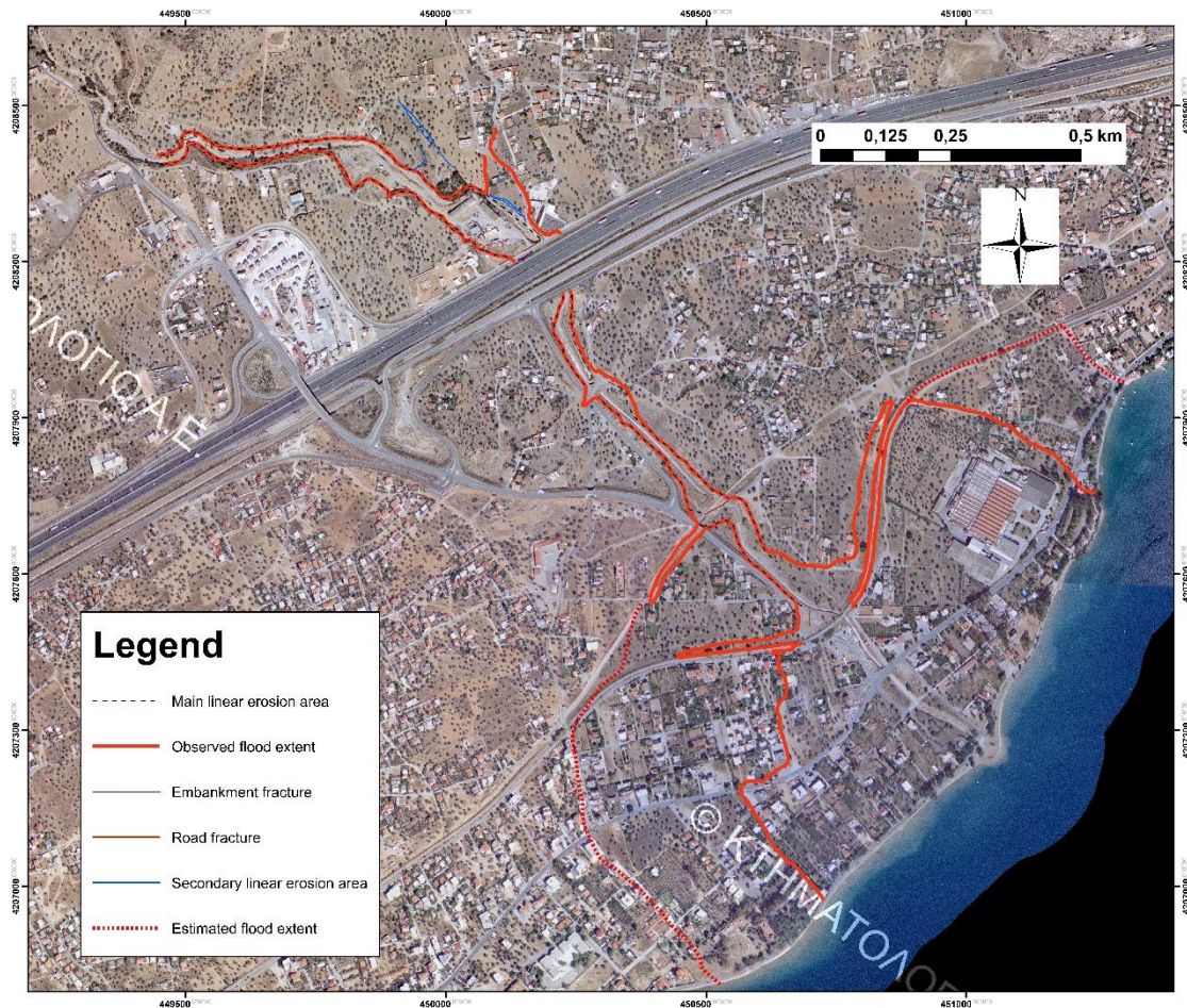
Χάρτης 6 : Χάρτης χαρτογραφημένων γραμμικών στοιχείων της περιοχής με υπόβαθρο τον ορθοφωτοχάρτη του Ελληνικού Κτηματολογίου. Διακρίνεται το όριο πλημμύρας, το πιθανό όριο πλημμύρας, οι αστοχίες στο οδόστρωμα και στο ανάχωμα της Εθνικής Οδού, το όριο διάβρωσης και μικρότερης κλίμακας εδαφικές διαβρώσεις.
