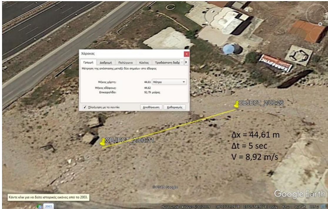
Εικόνα 2.3.13.6 : Απεικόνιση αρχικής και τελικής θέσης του αντικειμένου 2, καθώς και υπολογισμός της απόστασης \Delta x με τη χρήση του προγράμματος Google Earth Pro.
