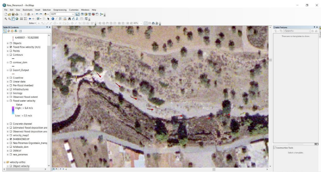
Εικόνα 2.3.12.13 : Απεικόνιση ροής υδάτων με μεγάλη ταχύτητα (κόκκινα βέλη) στο πρόγραμμα ArcMap με υπόβαθρο τον ορθοφωτοχάρτη του Ελληνικού Κτηματολογίου.
