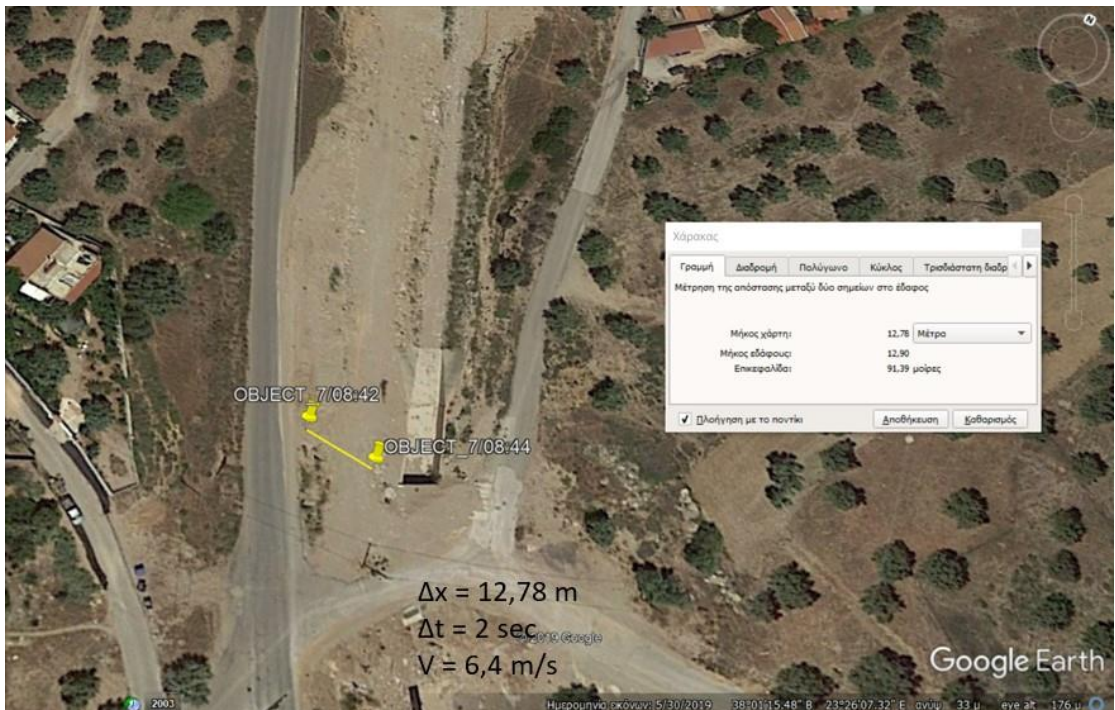
Εικόνα 2.3.13.21 : Απεικόνιση της αρχικής και τελικής θέσης του αντικειμένου 7, καθώς και υπολογισμός της απόστασης Δx με τη χρήση του προγράμματος Google Earth Pro.
