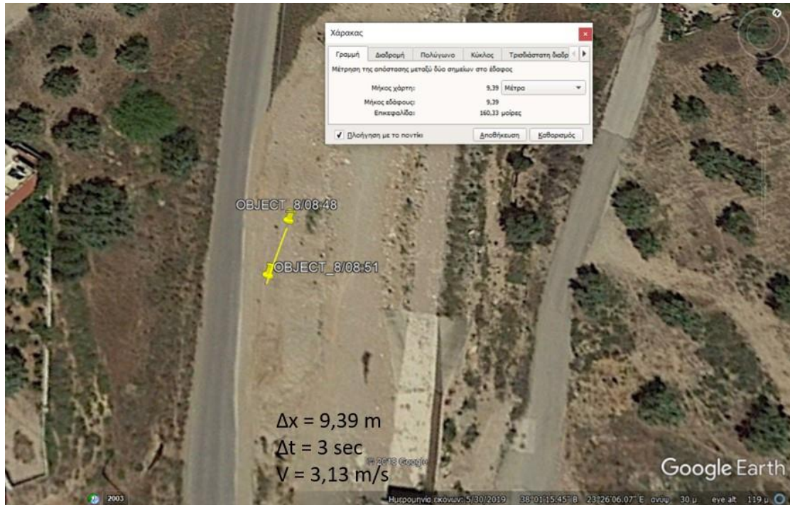
Εικόνα 2.3.13.24 : Απεικόνιση της αρχικής και τελικής θέσης του αντικειμένου 8, καθώς και υπολογισμός της απόστασης Δx με τη χρήση του προγράμματος Google Earth Pro.
