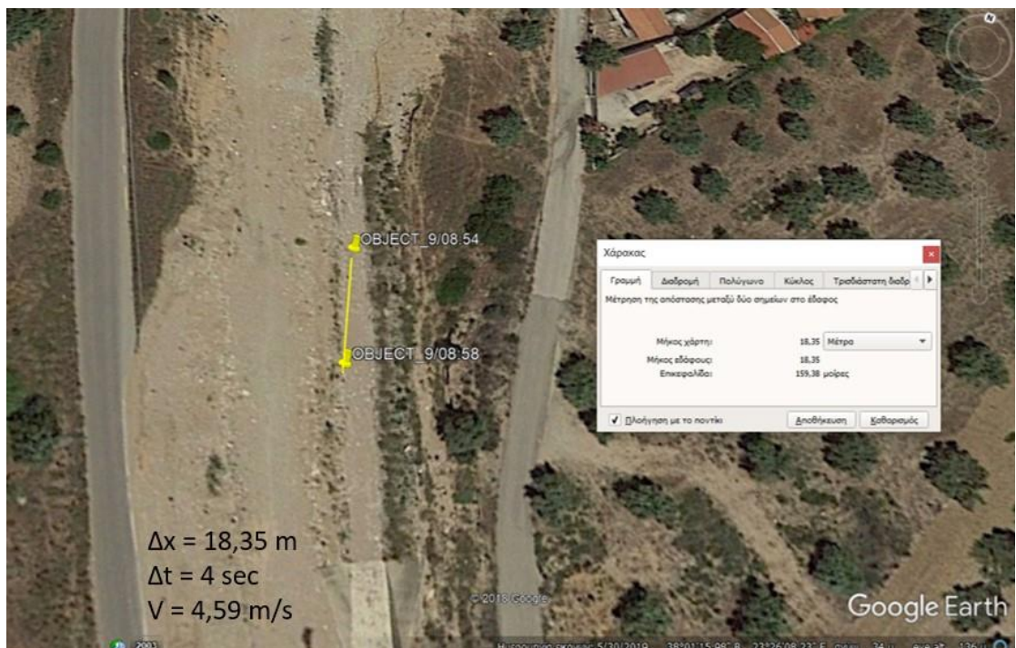
Εικόνα 2.3.13.27 : Απεικόνιση της αρχικής και τελικής θέσης του αντικειμένου 9, καθώς και υπολογισμός της απόστασης Δx με τη χρήση του προγράμματος Google Earth Pro.
