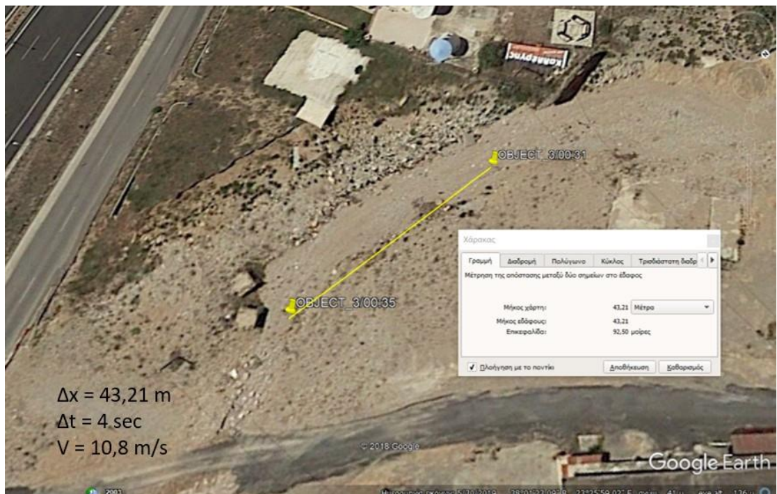
Εικόνα 2.3.13.9 : Απεικόνιση αρχικής και τελικής θέσης του αντικειμένου 3, καθώς και υπολογισμός της απόστασης Δx με τη χρήση του προγράμματος Google Earth Pro.
