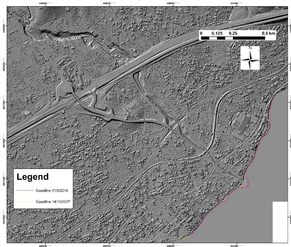
Χάρτης 11 : Χάρτης ακτογραμμής πριν (14/10/2017) και μετά το πλημμυρικό γεγονός (31/8/2018) με υπόβαθρο το Ψηφιακό Μοντέλο Επιφανείας (DSM).
