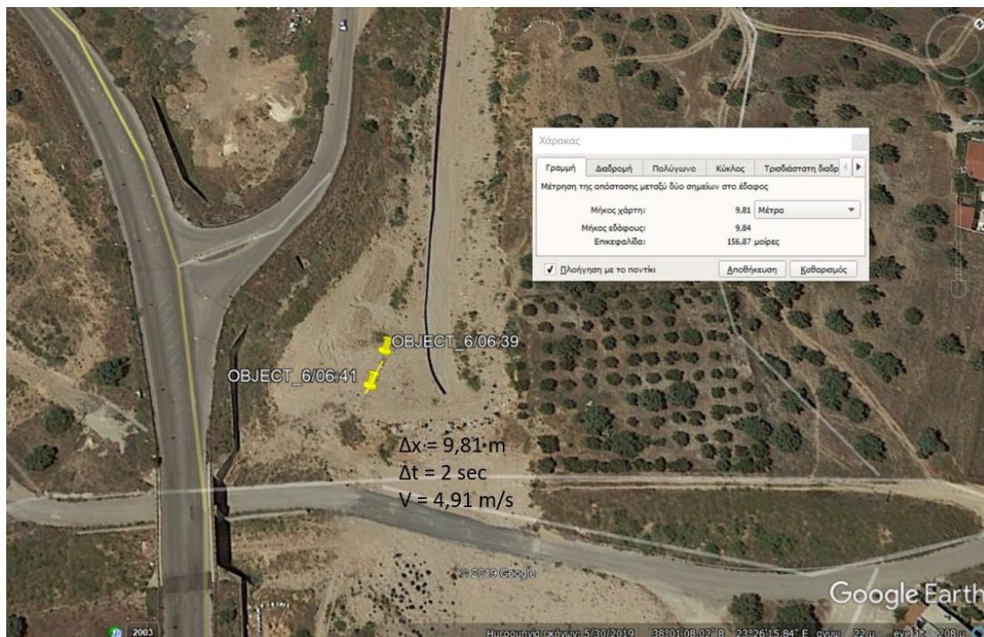
Εικόνα 2.3.13.18 : Απεικόνιση αρχικής και τελικής θέσης του αντικειμένου 6, καθώς και υπολογισμός της απόστασης Δx με τη χρήση του προγράμματος Google Earth Pro.
