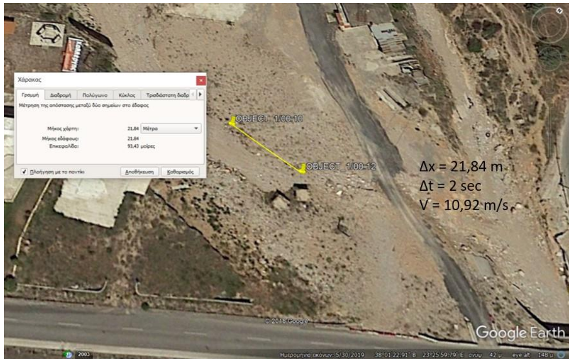
Εικόνα 2.3.13.3 : Απεικόνιση αρχικής και τελικής θέσης του αντικειμένου 1, καθώς και υπολογισμός της απόστασης \Delta x με τη χρήση του προγράμματος Google Earth Pro.
