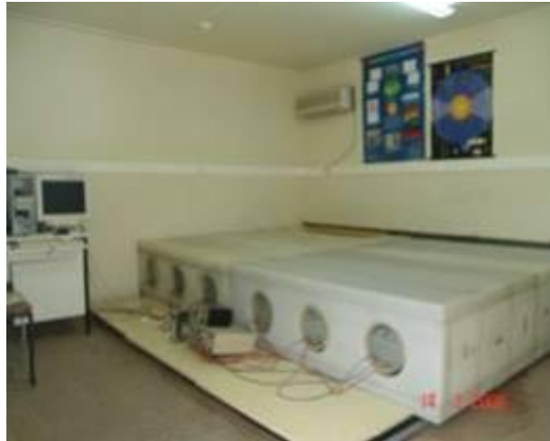
Εικόνα 2.1: Ο μετρητής νετρονίων (τύπου 3NM-64) που βρίσκεται στον τομέα της πυρηνικής φυσικής του πανεπιστήμιου Αθηνών.
