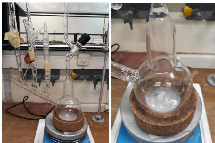
Εικόνα 18: Συσσκευή πολυμερισμού που περιλαμβάνει την αμπούλα του απαρχητή και τις αμπούλες των μονομερών (αριστερά), το διάλυμα του απαρχητή και του μονομερούς μετά την θραύση των γυάλινων υμένων (δεξιά).
